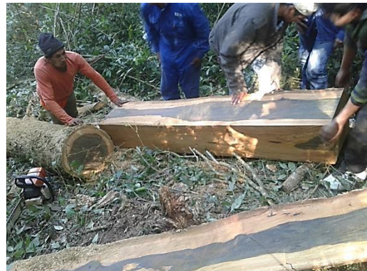
Foto 2: Dimensionamiento y cantoneado de la troza
