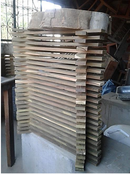
Foto 4: Secado de la madera
