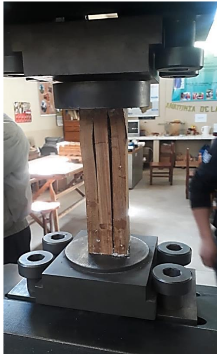
Figura 11: Tipos de falla compresión paralela al grano
