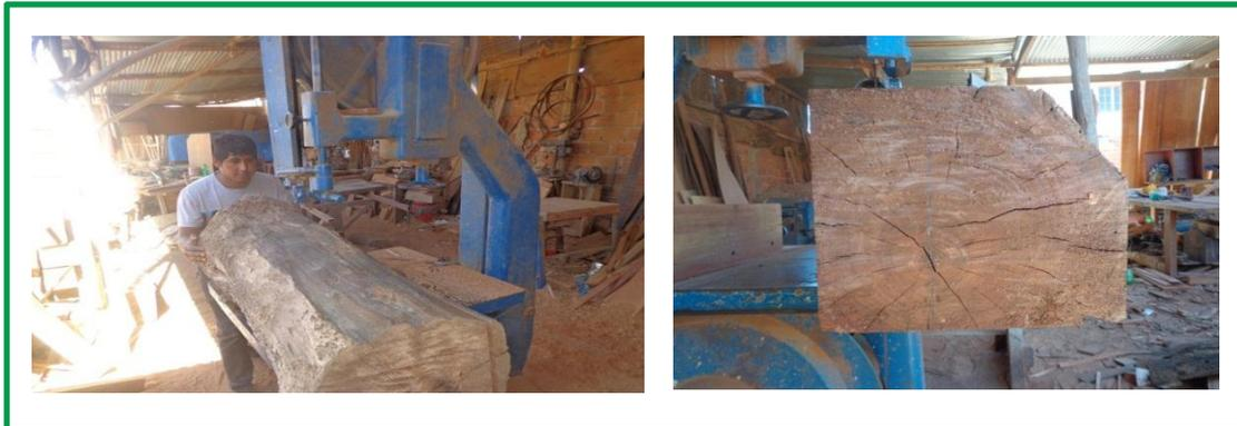
**3.3.1.6. Obtención de las probetas dentro de las trozas.** La obtención de las probetas se realizó de acuerdo a las normas correspondientes en cada uno de los ensayos de trabajabilidad, para lo mismo se utilizaron probetas en números y dimensiones como se refleja en la siguiente tabla. en las mismas probetas se realizó varios ensayos como: cepillado, lijado, taladrado, moldurado y torneado.
