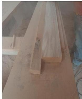
*(Lijado de las Probetas)*
