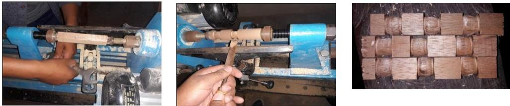
(Maquina Torno) (Torneado de las Probetas) (Resultado final del Torneado)
