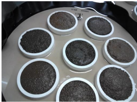
Muestras totalmente saturadas (después de 24 hrs.)
