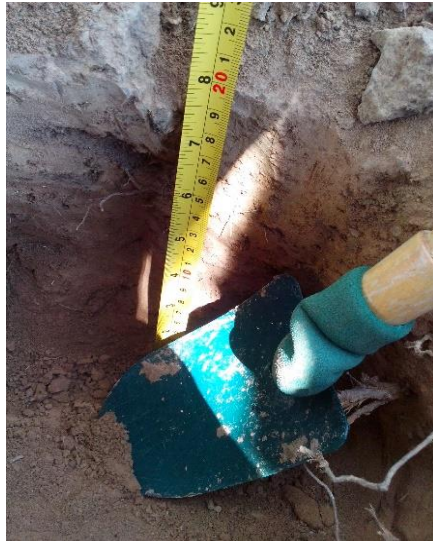
Extracción de la muestra a una profundidad de 0 – 20 cm.
