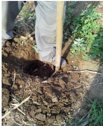
Cavado en el suelo del lugar seleccionado para la extracción de la muestra, procurando no alterar significativamente el entorno
