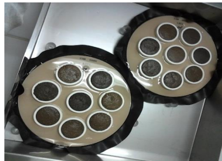
Muestras totalmente saturadas (después de 24 hrs.)
