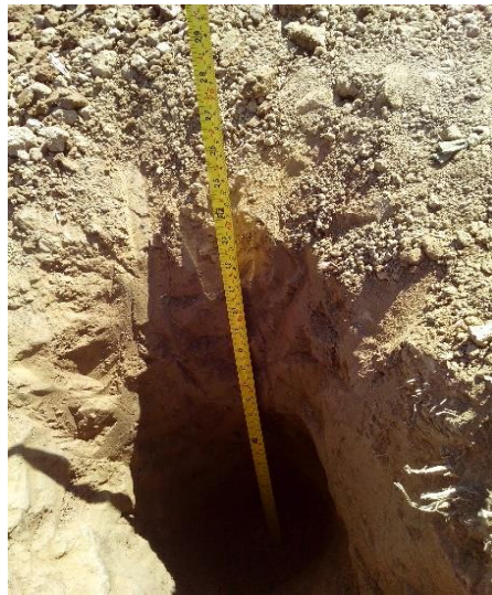
Extracción de la muestra a una profundidad de 20 – 40 cm.
