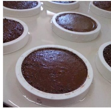
Muestras totalmente saturadas (después de 24 hrs.)
