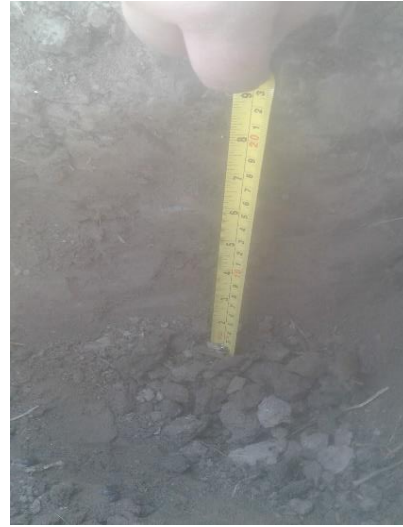
Extracción de la muestra a una profundidad de 0 – 20 cm.
