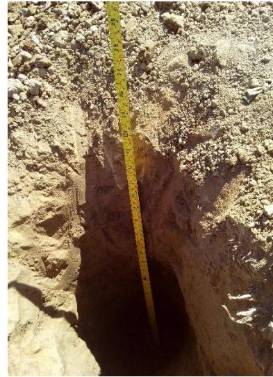
Extracción de la muestra a una profundidad de 20 – 40 cm.
