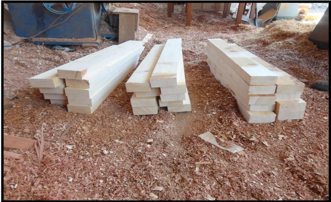
**Fotografía 12 Probetas de Cepillado y lijado**
