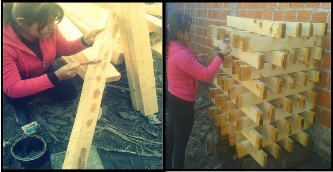
**Fotografía 11 Proceso de parafinado de las probetas de ciprés**
