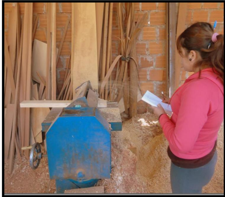
**Fotografía 13 Ensayo de cepillado (Grueseadora)**
