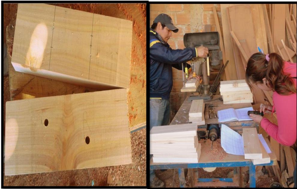
**Fotografía 14 Ensayo de taladrado**
