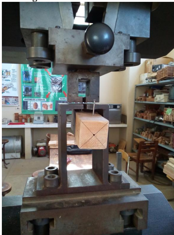
Fotografía N° 6 Extracción de clavos
