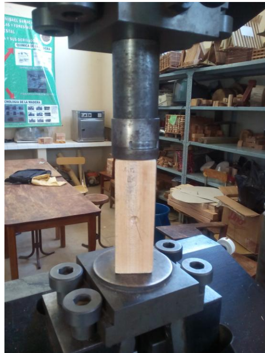
Fotografía N° 4 Determinación de la dureza de los extremos
