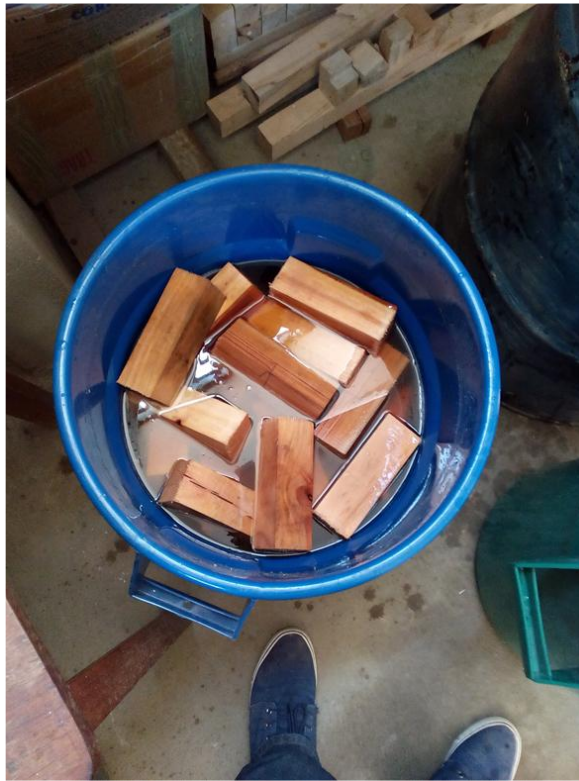
Fotografía N° 6 Probetas acondicionadas para el ensayo en estado verde
