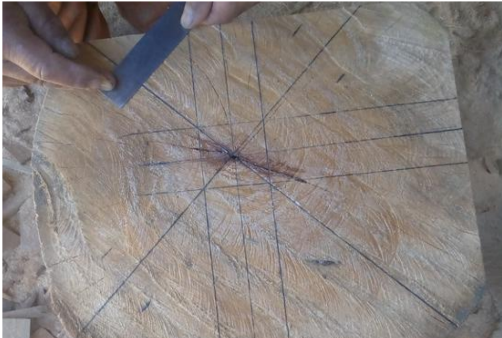
Fotografía N° 3 Dimensionamiento para las probetas
