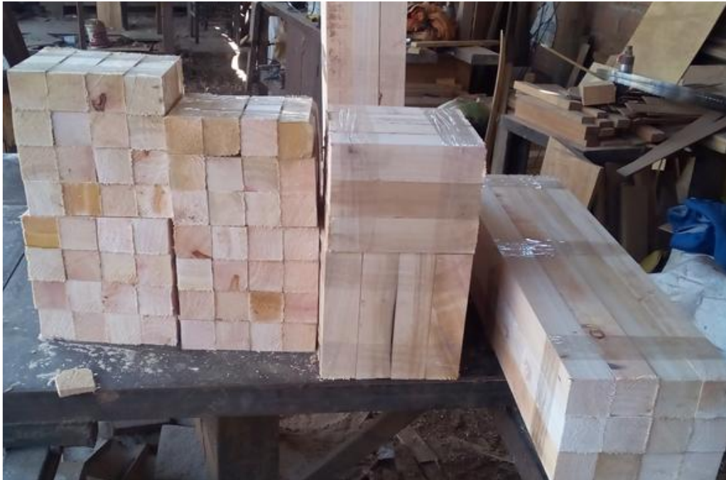
Fotografía N° 5 Probetas preparadas para el ensayo de laboratorio
