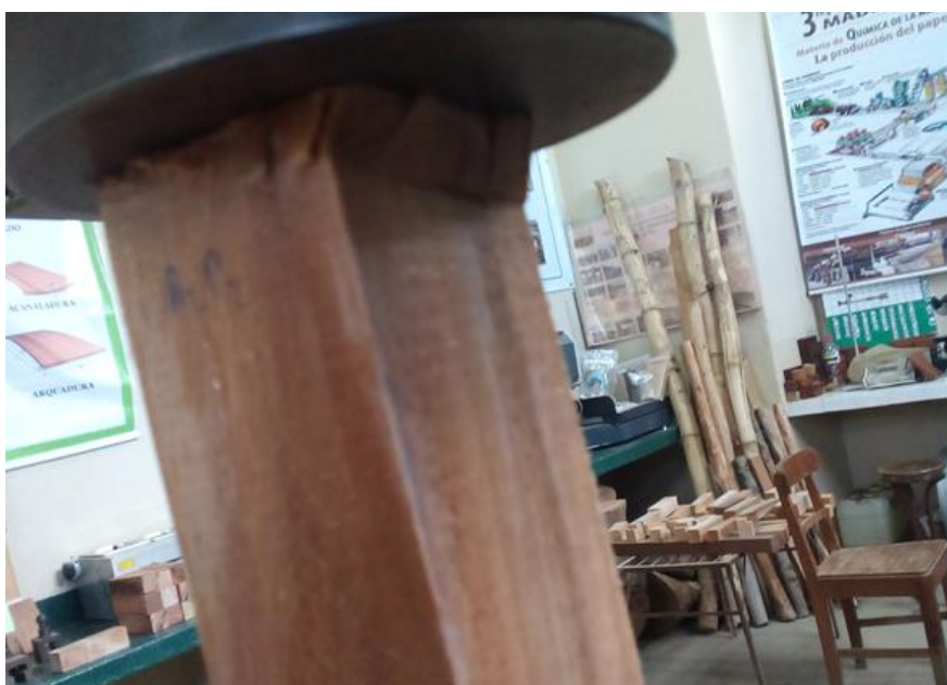
Fotografía N° 8 Fallo en el ensayo de compresión paralela, aplastamiento
