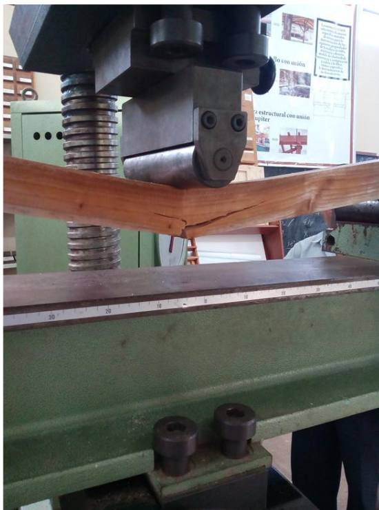
Fotografía N° 7 Fallo en el ensayo de flexión estática, tracción simple
