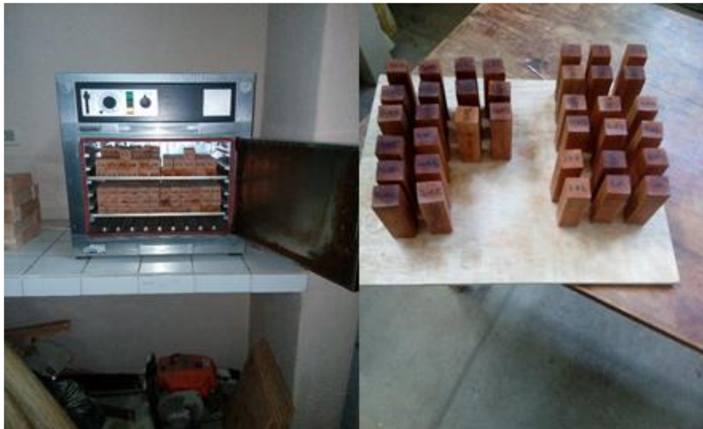
Fotografía N° 8 Probetas colocas al horno y parafinado de las mismas
