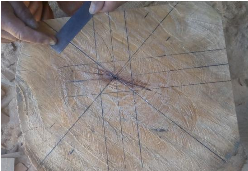
Fotografía N° 3 Dimensionamiento para las probetas
