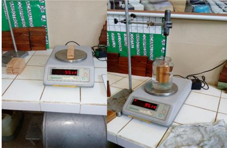
Fotografía N° 8 Probetas colocas al horno y parafinado de las mismas
