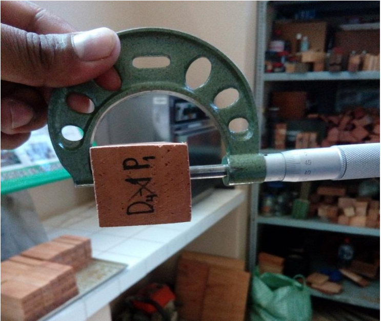
Fotografía N° 6 Toma de datos dimensionales de las probetas
