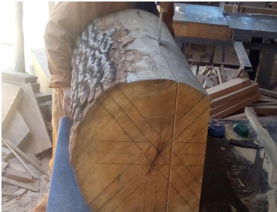
Fotografía N° 4 Corte en la sierra sinfín de las probetas
