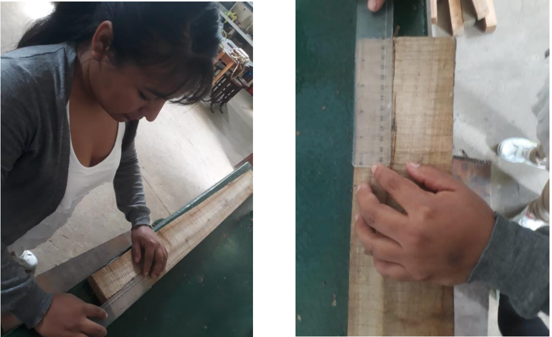
Medición de las grietas en las probetas de secado
