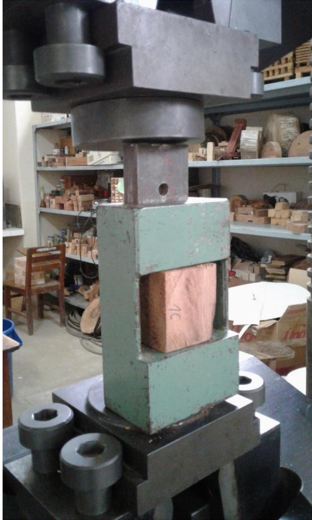
MÁQUINA DE ENSAYOS UNIVERSAL EJECUTANDO EL ENSAYO DE FLEXIÓN ESTÁTICA
