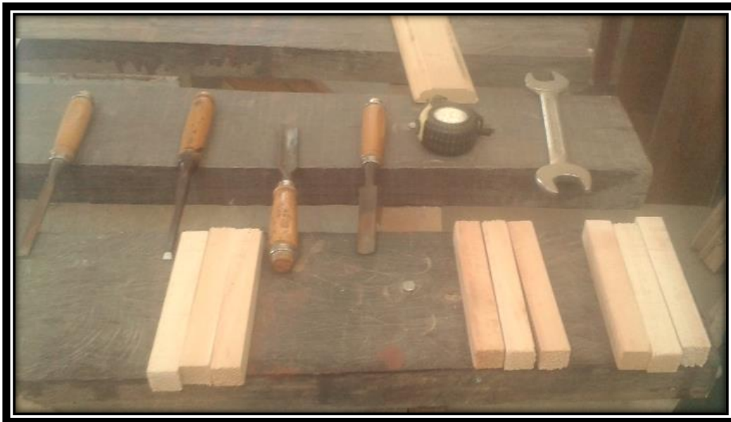
Fotografía N° 13 Herramientas y probetas para el ensayo de torneado.
