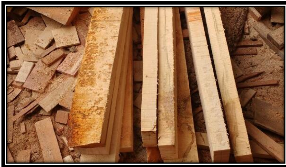
Fotografía N° 6 Obtención de probetas de sobre medida para los ensayos de taladrado y moldurado.
