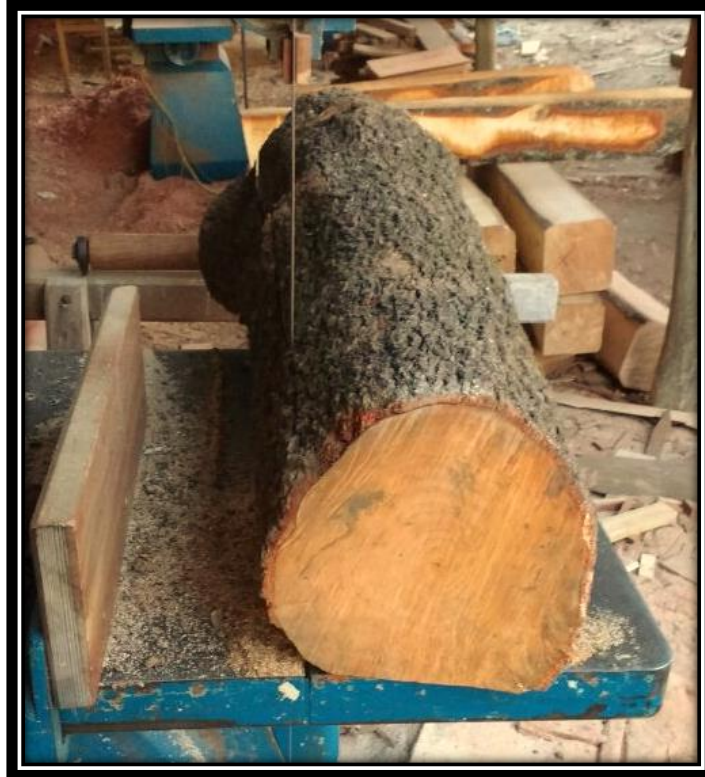
Fotografía N° 2 Proceso de aserrío para la obtención de las probetas.
