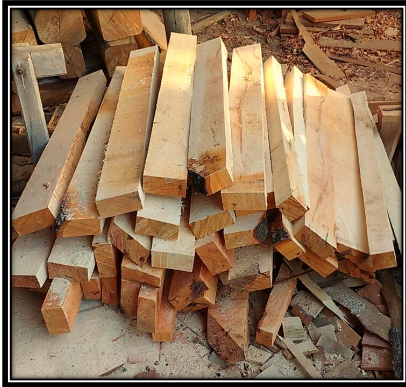
Fotografía N° 5 Obtención de probetas en sobre medida de cepillado y lijado.
