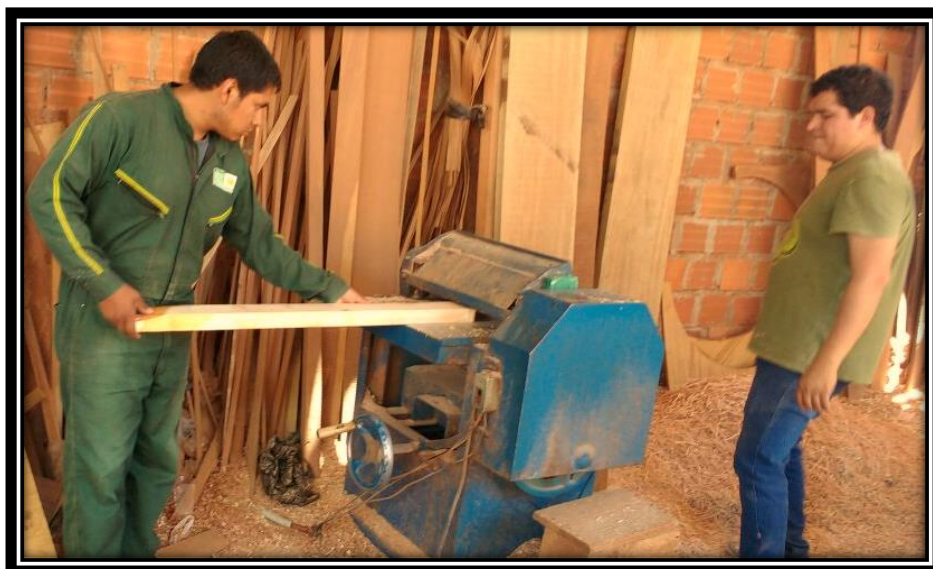
Fotografía N° 10 ensayo de cepillado (grueseadora).
