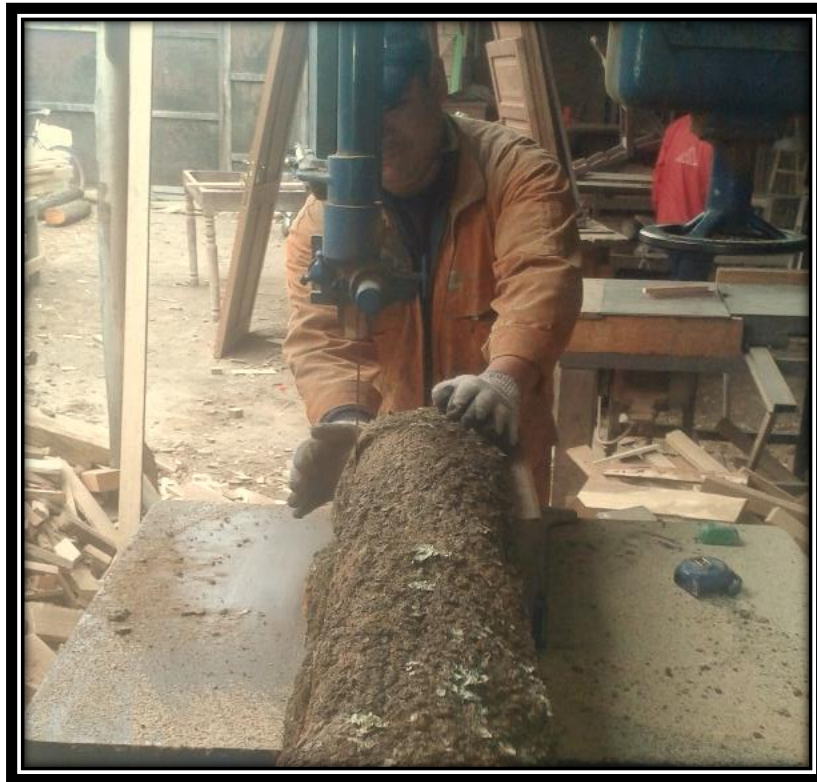
Fotografía N° 3 Rayando las trozas en la sierra sin fin.
