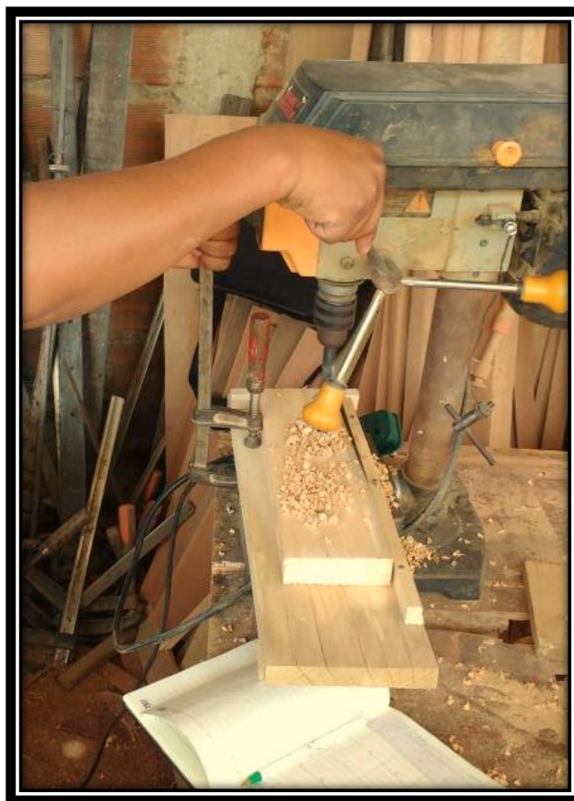
Fotografía N° 11 ensayo de taladrado.
