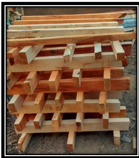
Fotografía N° 9 Secado de las probetas al aire libre.
