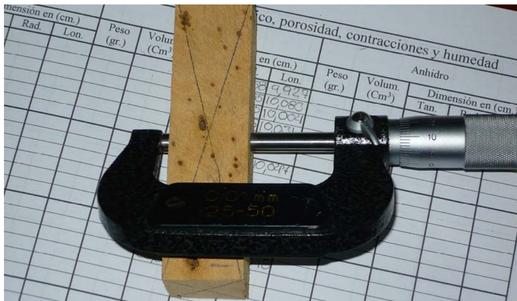
Fotografía N° 2 Registro de los datos dimensionales de la probeta
