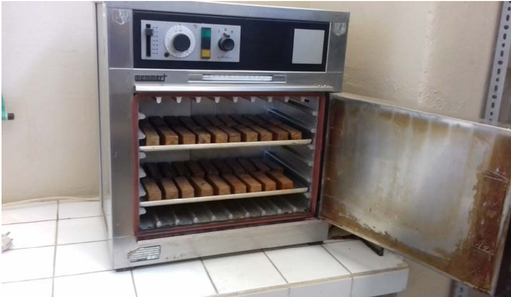
Fotografía N° 4 Parafinado de las probetas en el calentador a baño María
