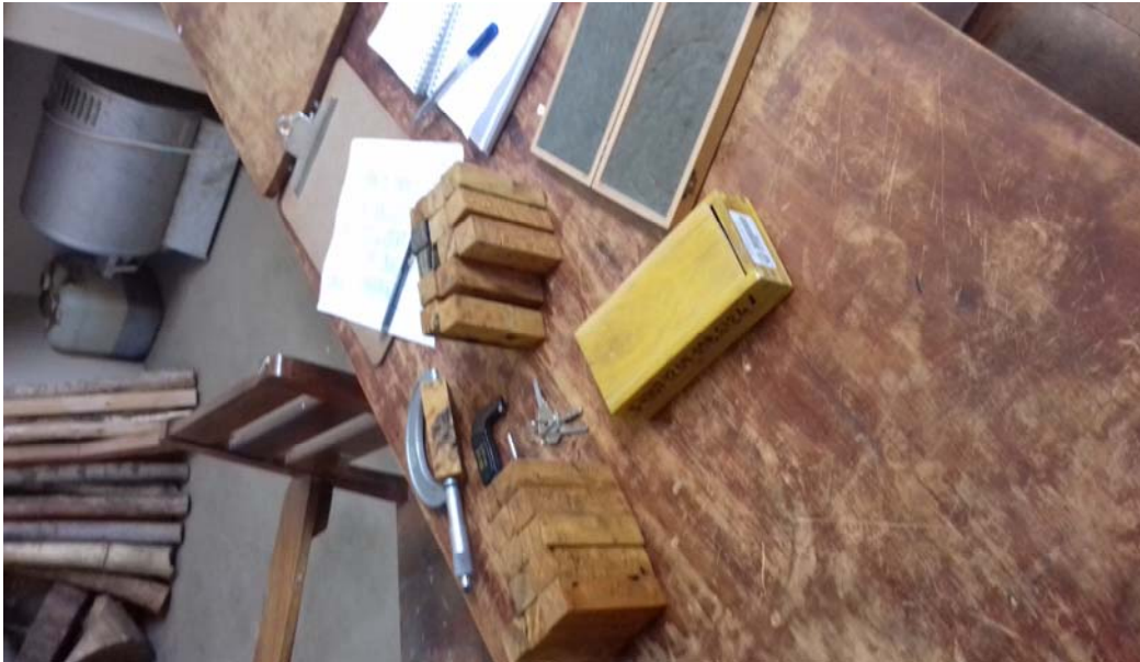
Fotografía N° 1 Toma de los datos dimensionales de las probetas
