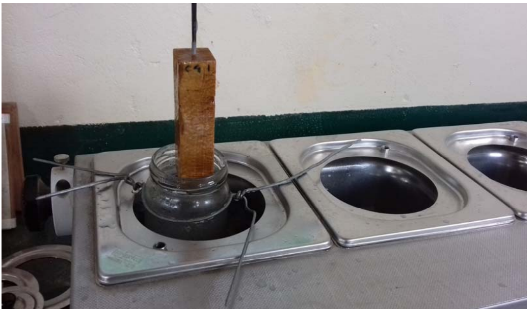
Fotografía N° 4 Parafinado de las probetas en el calentador a baño María
