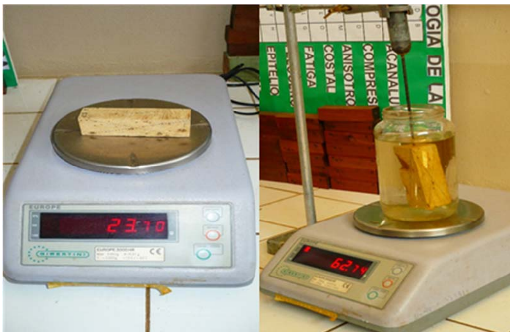
Fotografía N° 5 Toma de datos del peso y el volumen
