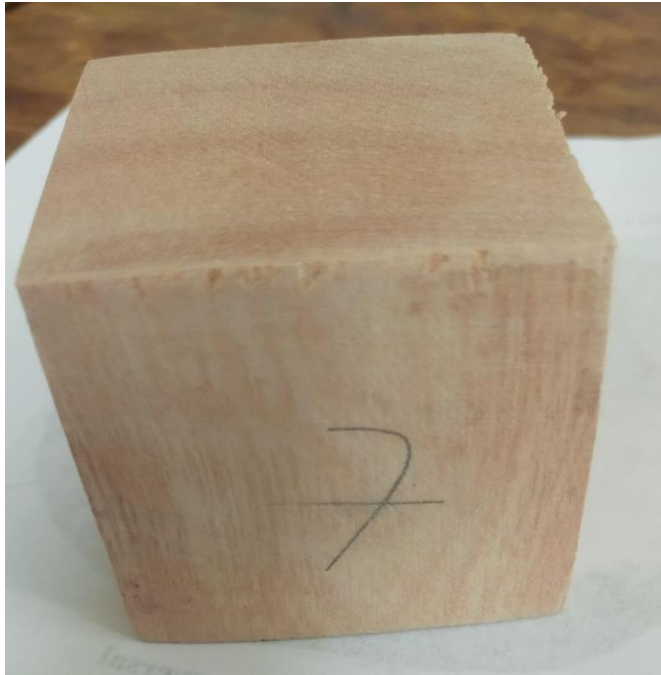
Fotografía 18. Veteado (sección tangencial) cubos de 5x5x5 cm.
