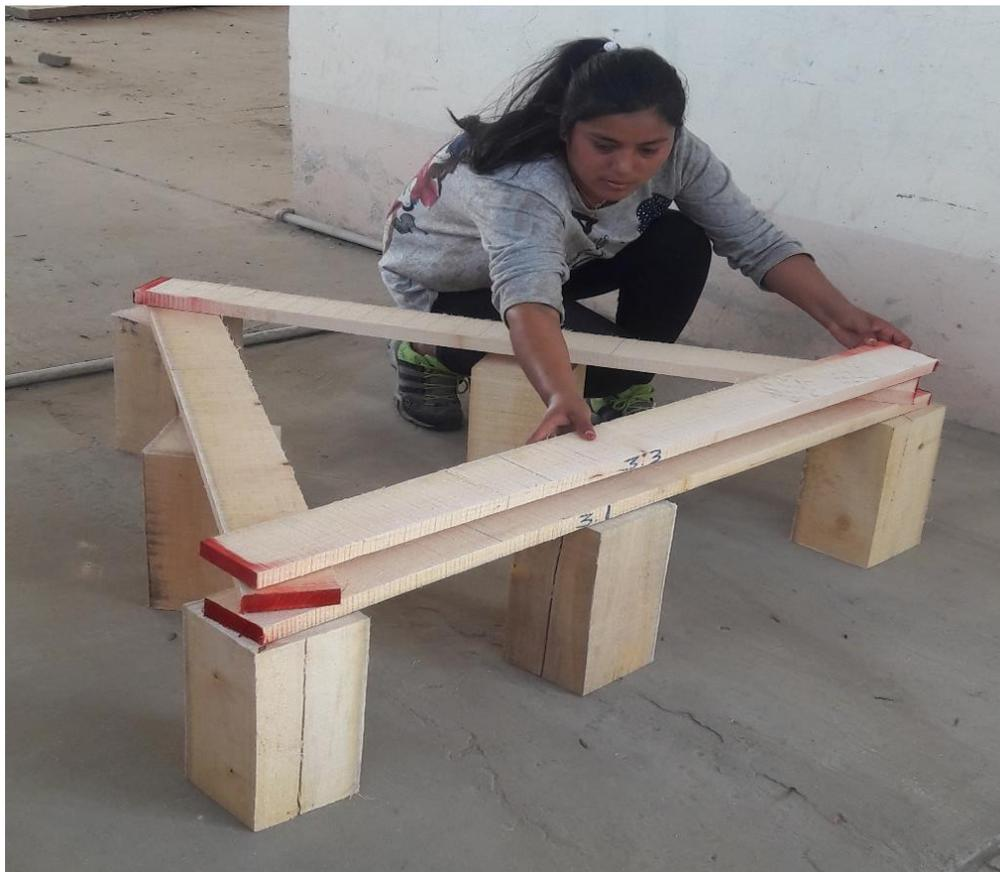
**Foto N° 12 Apilado de las tablas en triángulo horizontal**
