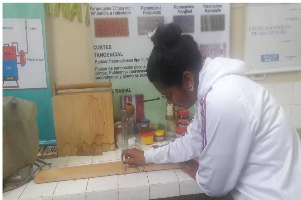
**Foto N° 16 Identificando defectos de arqueadura**
