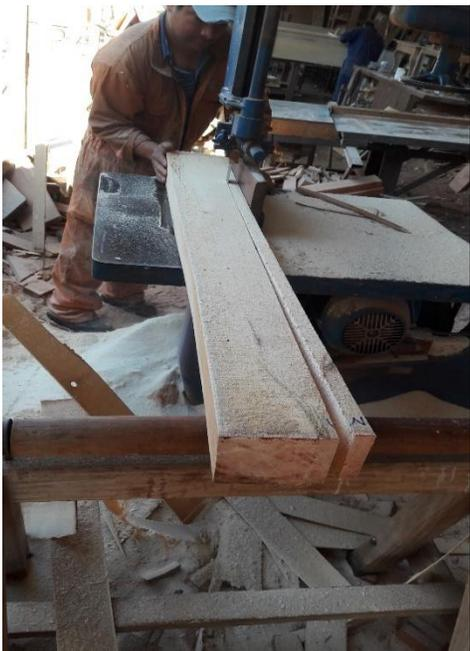
**Foto N° 7 Aserraje de las tablas para secado**
