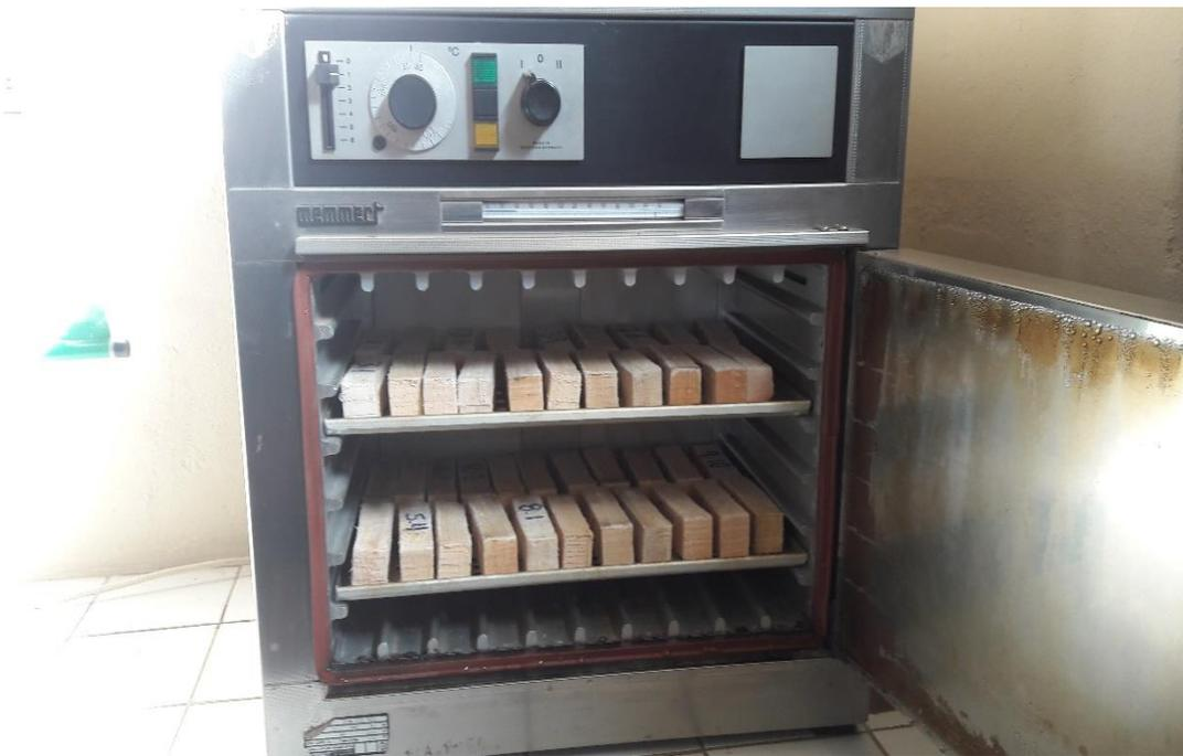
**Foto N° 10 Secado en la estufa para determinar el contenido de humedad**
