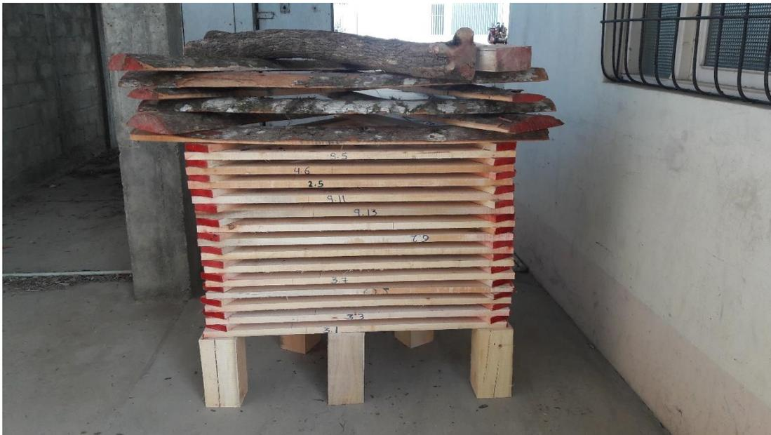
**Foto N° 14 Triangulo horizontal con sus pesos para evitar defectos posteriores**
