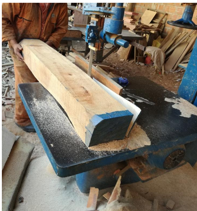
Fotografía N° 5: Aserrado del listón
