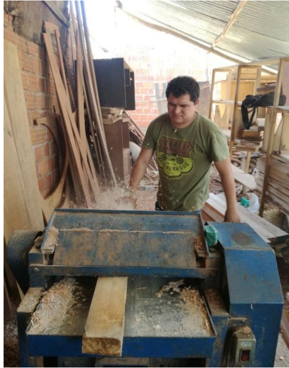
Fotografía N° 10: Trabajo de cepillado
