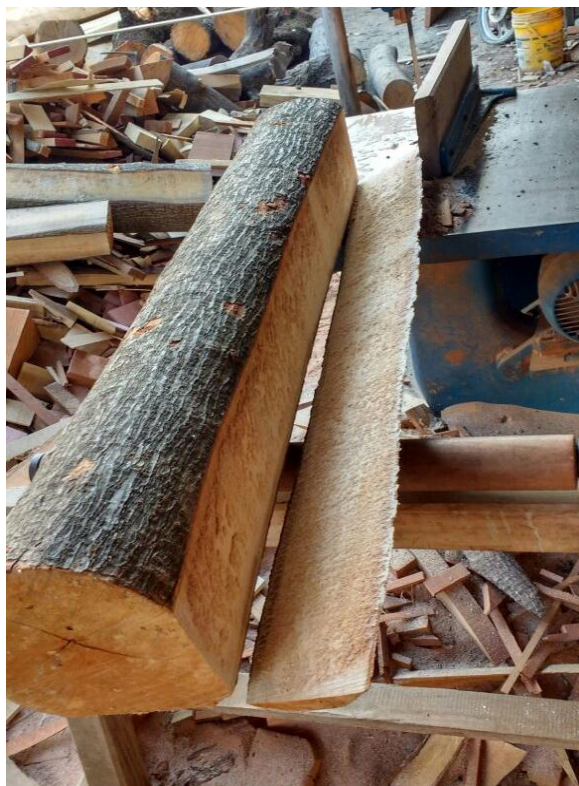
Fotografía N° 4: Descortezado de la troza
