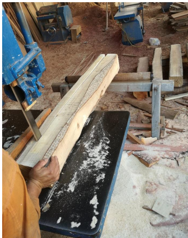
Fotografía N° 6: Obtención de tablas
