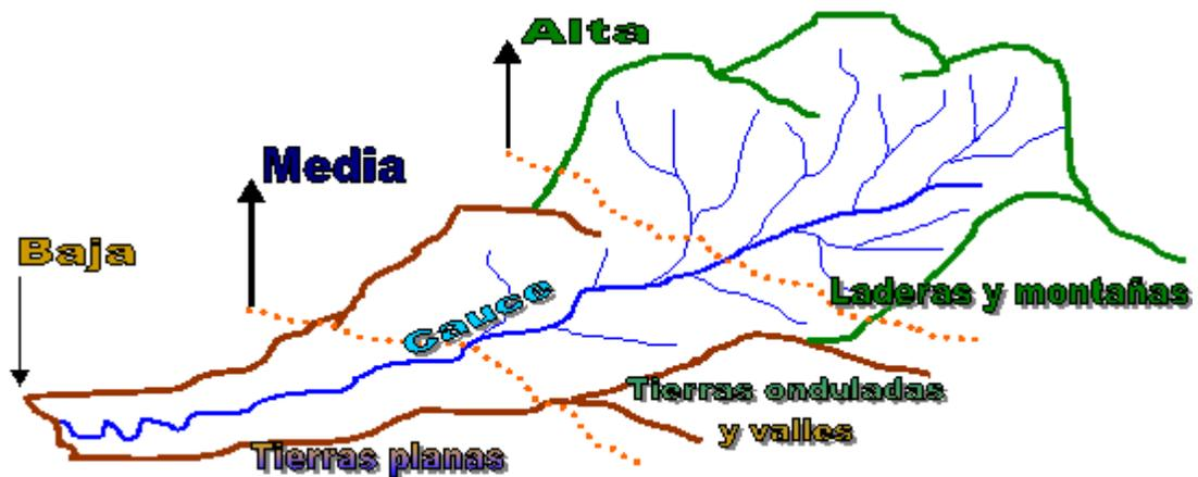
Figura N° 1. Partes de una Cuenca hidrográfica
