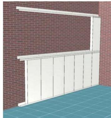
Una vez las guías están fijadas en la superficie de la pared instalar los paneles en los raíles.
