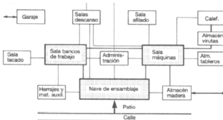
1 Esquema funcional de una carpintería
