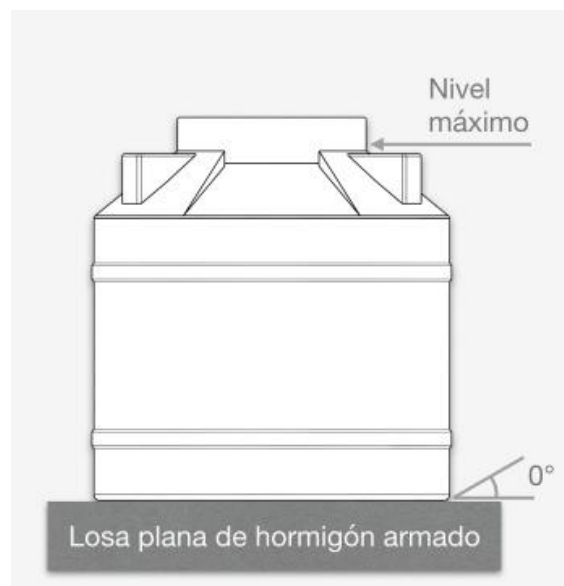
Figura 3.51 Esquema de un tanque de agua
