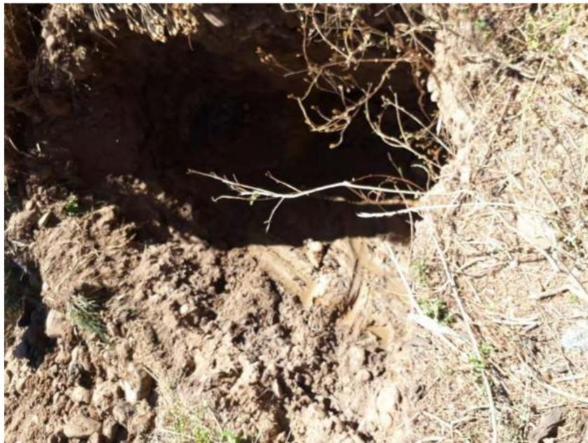
Excavación final para en ensayo S.P.T. Prof.= 2 mts
