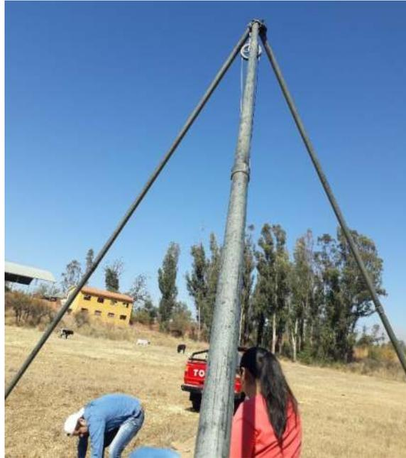
Realización del 1er ensayo S.P.T.
