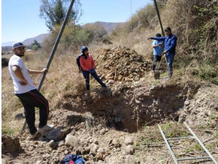
Montaje del martillo sobre el trípode para el estudio de penetración
