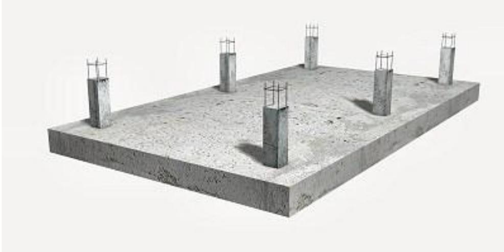
**Figura 26 Losa de Fundación**
