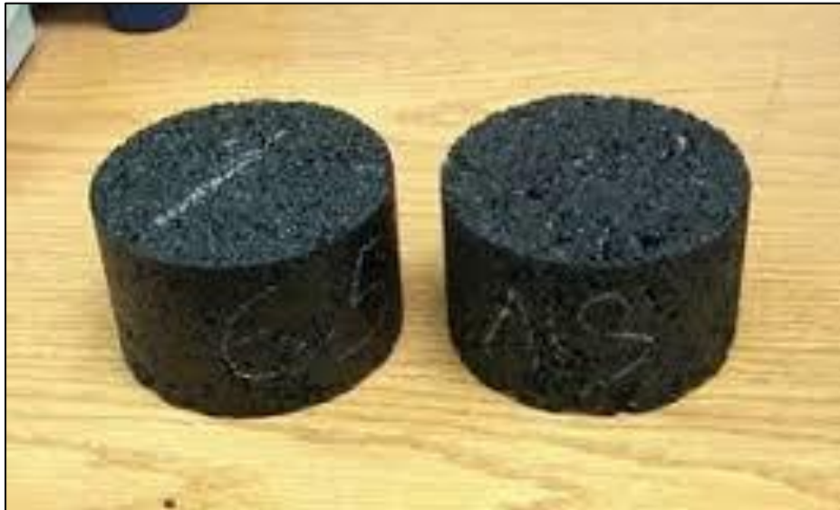
Imagen 3: Diseño de las briquetas según método Marshall
