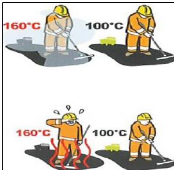
Imagen 7: Reducción de las temperaturas de colocación y compactación
