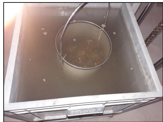
Imagen 8: Equipo para determinar el peso del árido sumergido
