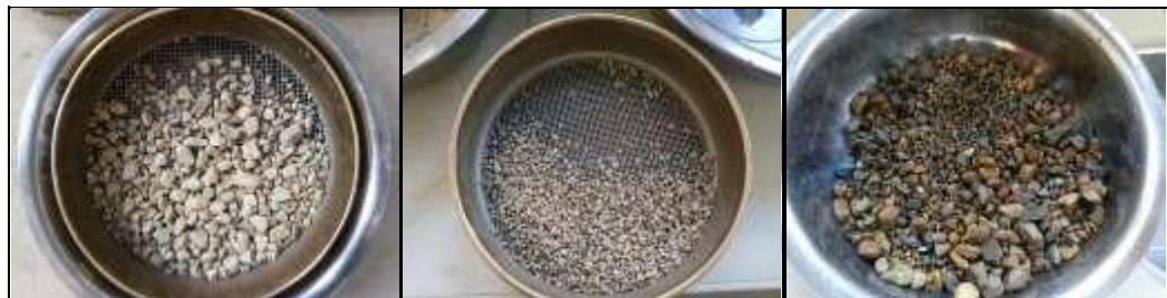
Imagen 17: Tamizado del material resultante, lavado y secado correspondiente
