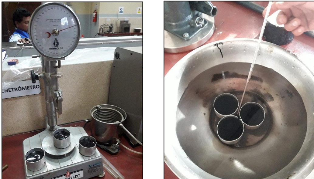
Imagen 32: Desarrollo del ensayo con penetrómetro de laboratorio
