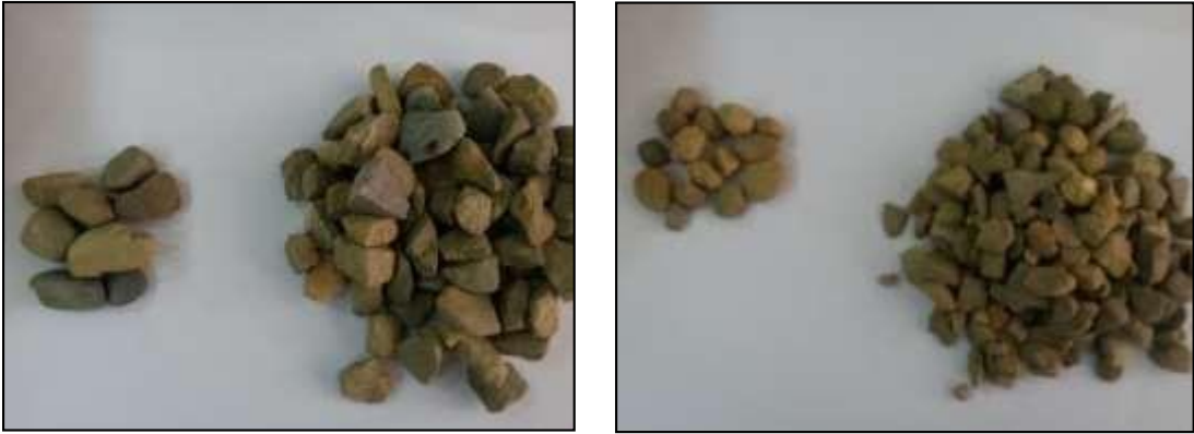
Imagen 19: Identificación visual de partículas fracturadas de acuerdo al conjunto de fracción separado
