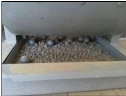
Imagen 16: Material resultante del desgaste
