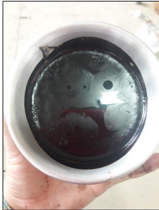
Imagen 33: Desarrollo del ensayo con Penetrómetro de laboratorio (Cemento asfáltico modificado con los diferentes porcentajes de cera de soya)
