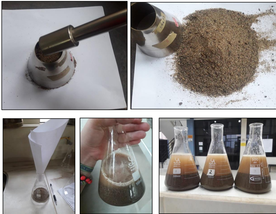
Imagen 12: Procedimiento de compactación y verificación de la pendiente que se genera en el árido
