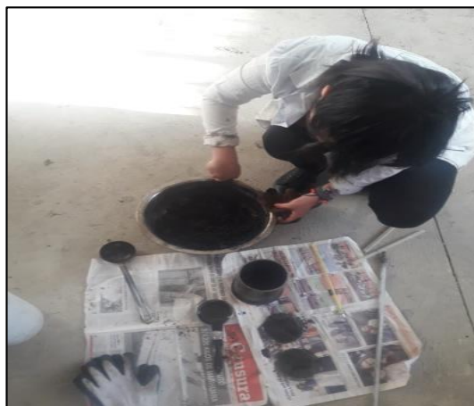
Imagen 48: Mezcla de los materiales pétreos y los diferentes porcentajes de asfalto (Convencional y modificación con cera de soya)
