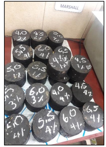
Imagen 50: Desmoldado de briquetas para su posterior clasificación según el tipo de porcentaje de asfalto usado en la mezcla
