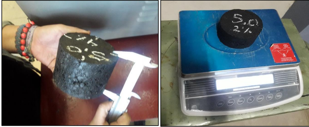
Imagen 51: Determinación de la altura con Vernier y peso seco para cada grupo de briqueta diseñada
