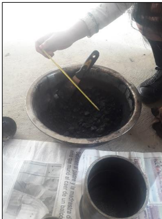
Imagen 48: Mezcla de los materiales pétreos y los diferentes porcentajes de asfalto (Convencional y modificación con cera de soya)
