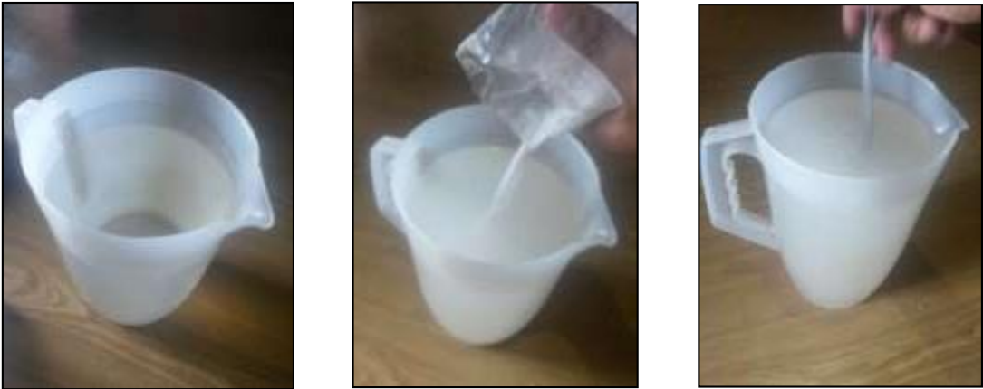
Imagen 20: Preparación de la solución de ensayo, Sulfato de sodio
