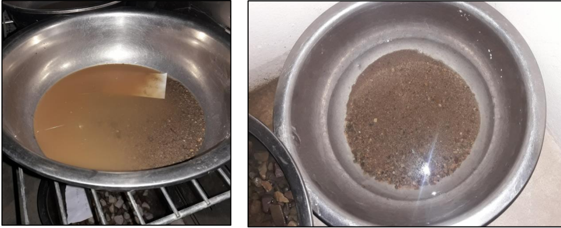
Imagen 9: Árido fino expuesto en remojo durante 24 horas
