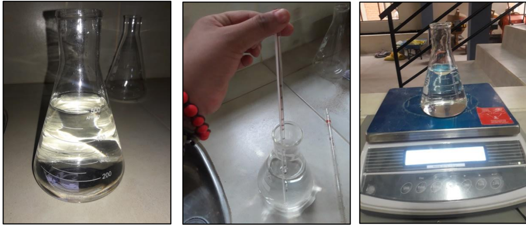
Imagen 21: Calibración del matraz
