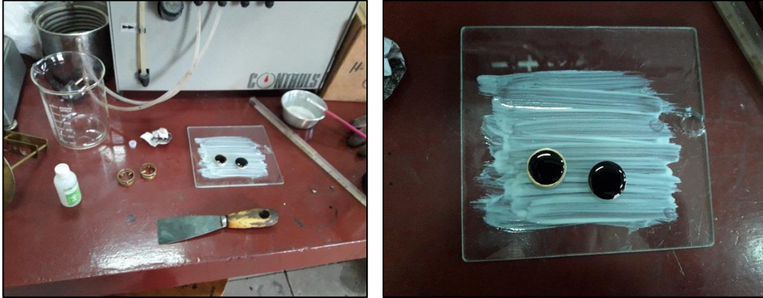
Imagen 39: Preparación de la muestra de ensayo, y posterior vertido a los anillos correspondientes
