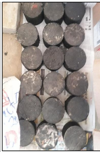
Imagen 50: Desmoldado de briquetas para su posterior clasificación según el tipo de porcentaje de asfalto usado en la mezcla
