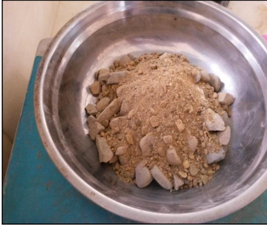
Imagen 46: Mezcla de agregado para la conformación de las mezclas asfálticas
