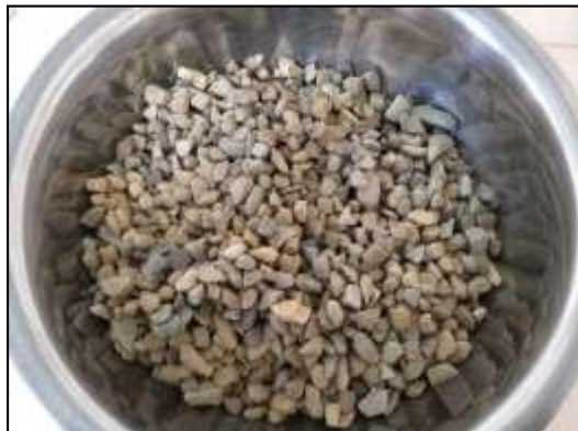
Imagen 14: Muestra de material y esferas a ser introducidas en la Máquina de Los Ángeles
