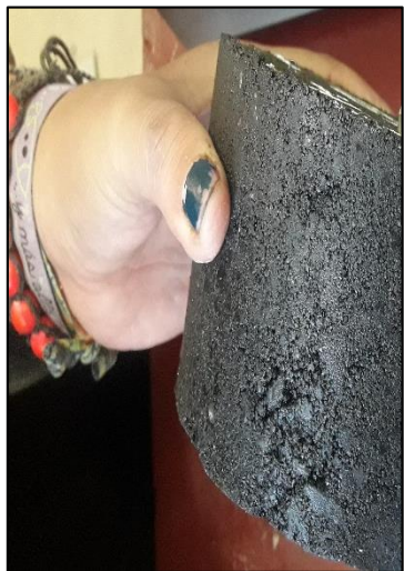
Imagen 50: Desmoldado de briquetas para su posterior clasificación según el tipo de porcentaje de asfalto usado en la mezcla
