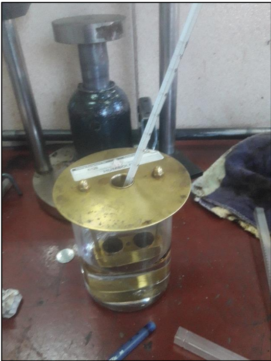
Imagen 41: Determinación del punto de ablandamiento para el cemento asfáltico modificado con diferentes porcentajes de cera de soya
