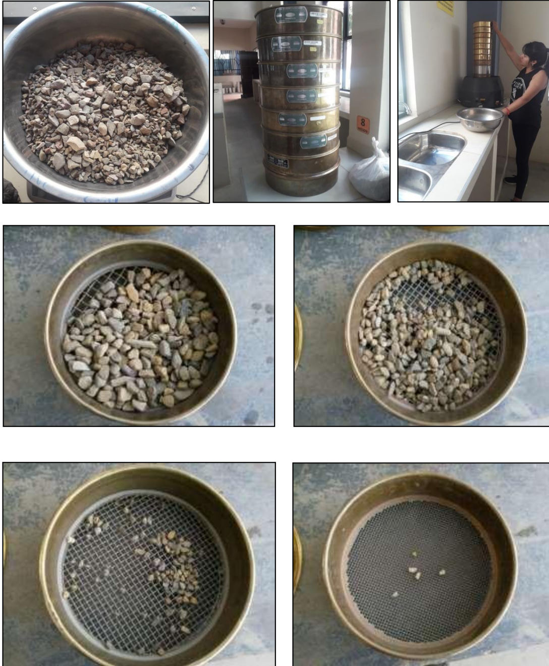
Imagen 6: Procedimiento de tamizado del agregado grueso
