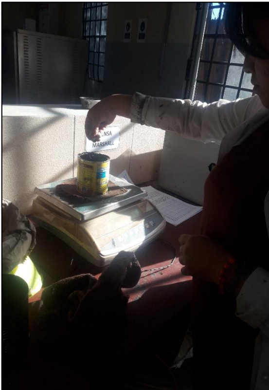
Imagen 46: Mezcla de agregado para la conformación de las mezclas asfálticas
