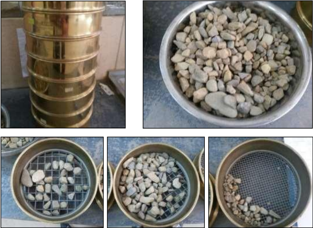
Imagen 18: Separación de fracciones según los tamices especificados
