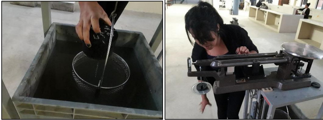
Imagen 52: Peso sumergido de cada grupo de briqueta diseñada
