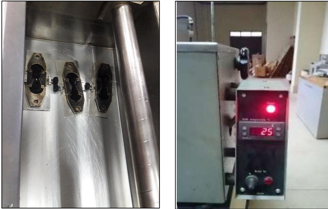
Imagen 35: Muestra en baño de agua a 25° C
