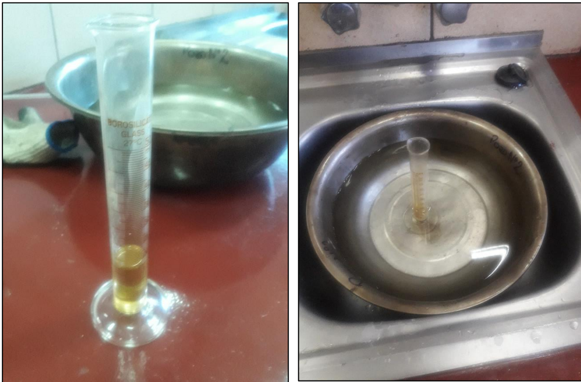
Imagen 43: Introducción de la cera de soya (estado líquido) en la probeta y posterior proceso de baño María a temperatura de 17 – 20°C
