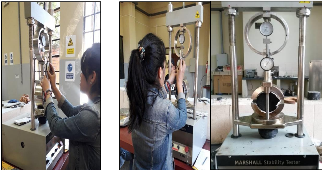
Imagen 55: Rotura de briquetas diseñadas
