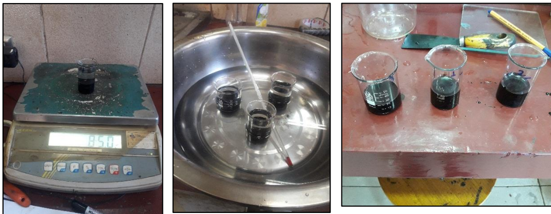
Imagen 30: Determinación de la densidad del cemento asfáltico
