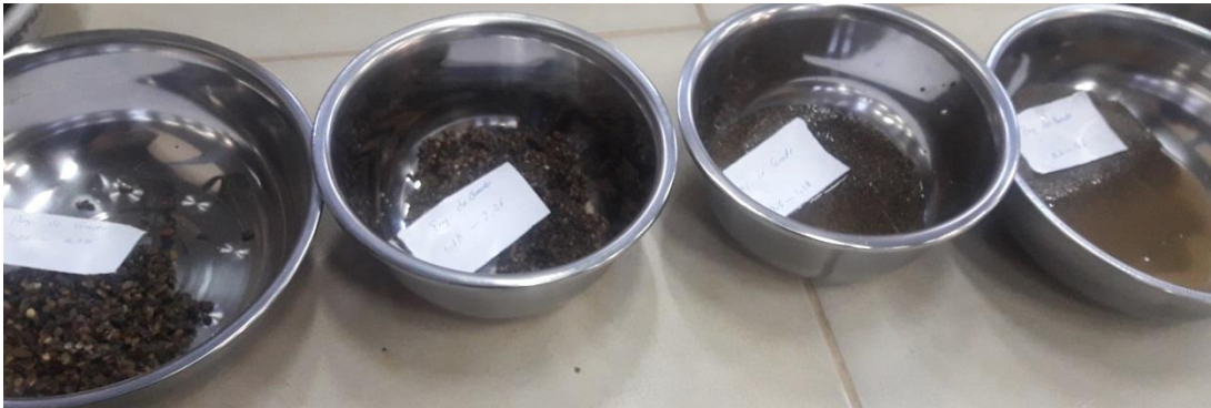
Imagen 21: Inmersión en sulfato de sodio del agregado grueso
