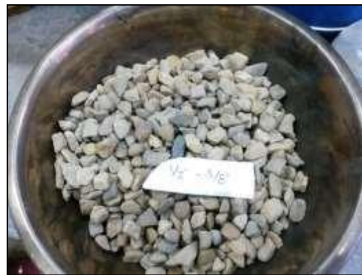
Imagen 13: Muestra de ensayo tamizado según lo especificado
