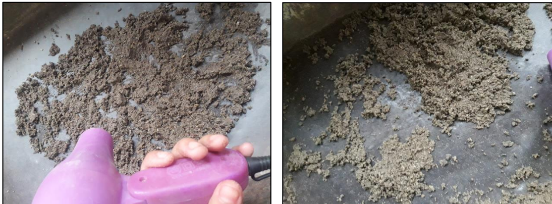
Imagen 10: Secado superficial del árido fino
