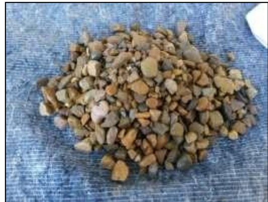
Imagen 17: Secado superficialmente del árido grueso
