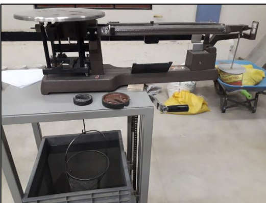
Imagen 8: Equipo para determinar el peso del árido sumergido
