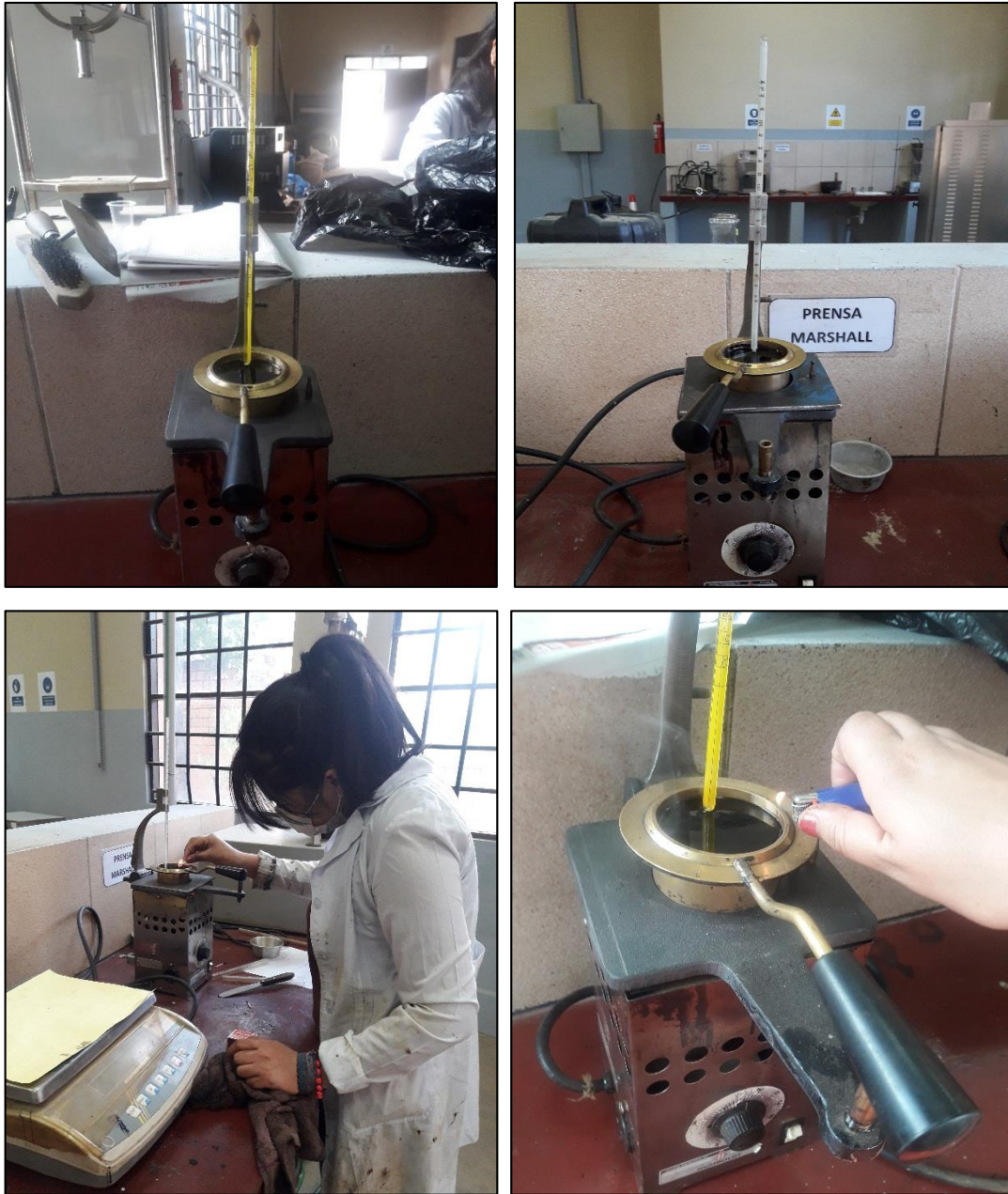
Imagen 38: Procedimiento para determinar el Punto de inflamación (Cemento asfáltico modificado con los diferentes porcentajes de cera de soya)
