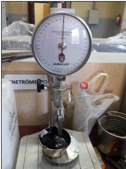
Imagen 33: Desarrollo del ensayo con Penetrómetro de laboratorio (Cemento asfáltico modificado con los diferentes porcentajes de cera de soya)
