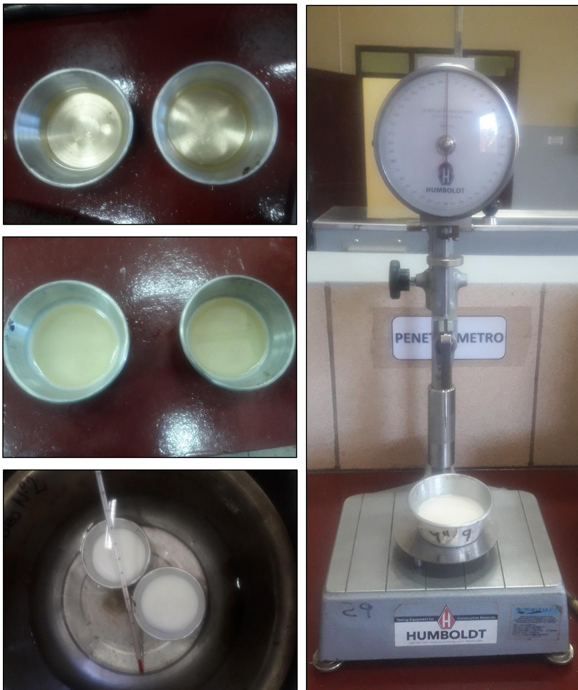
Imagen 45: Penetración de la cera de soya, previamente llevado a la temperatura establecida mediante baño María según norma
