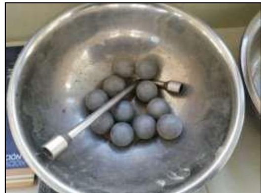
Imagen 14: Muestra de material y esferas a ser introducidas en la Máquina de Los Ángeles
