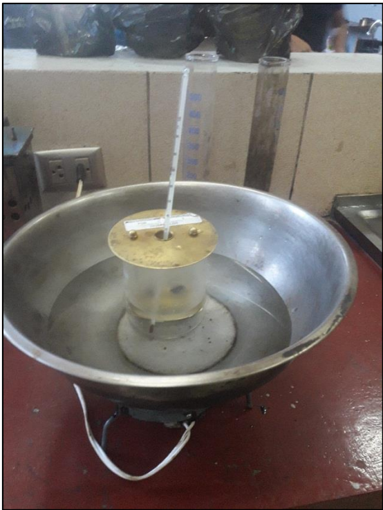
Imagen 41: Determinación del punto de ablandamiento para el cemento asfáltico modificado con diferentes porcentajes de cera de soya
