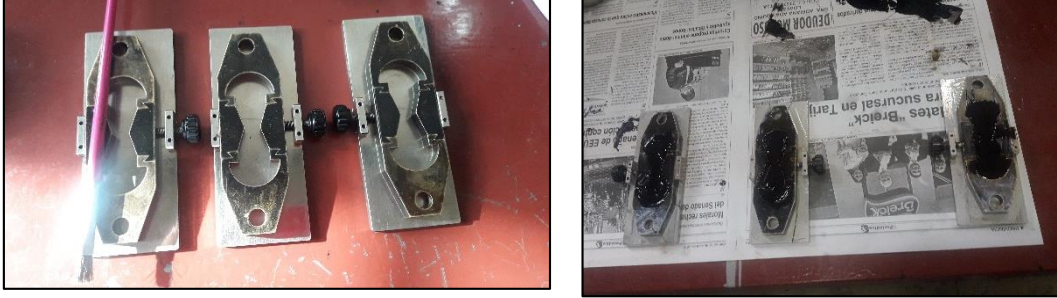
Imagen 34: Vertido de la muestra de cemento asfáltico a los moldes para el ensayo
