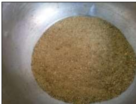
Imagen 11: Muestra saturada superficialmente seca
