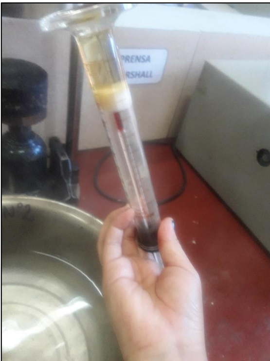
Imagen 44: Proceso para la determinación del punto de fusión de la cera de soya
