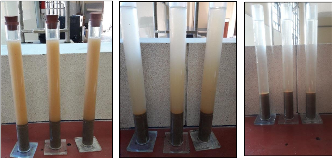
Imagen 27: Colocación de material en la probeta más la solución de ensayo
