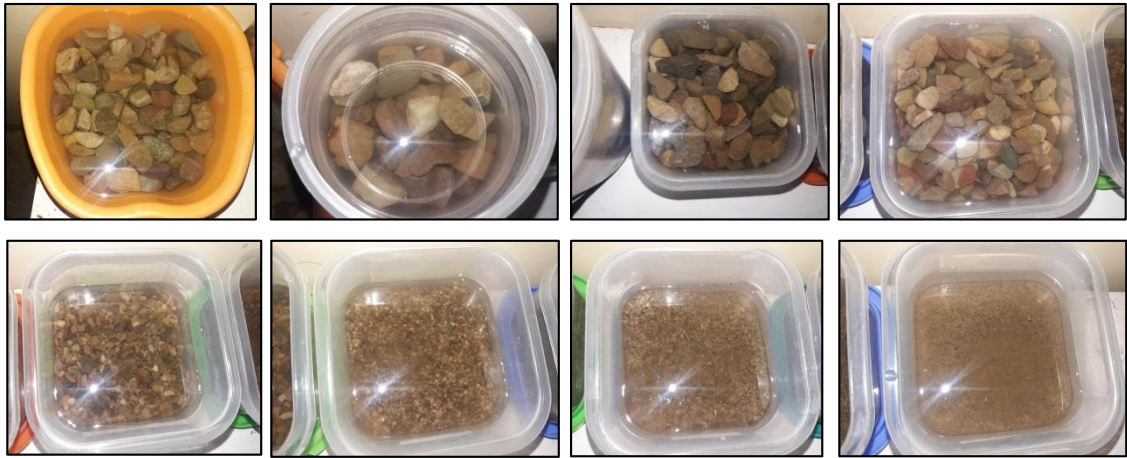
Imagen 22: Inmersión en sulfato de sodio del agregado fino (arena)
