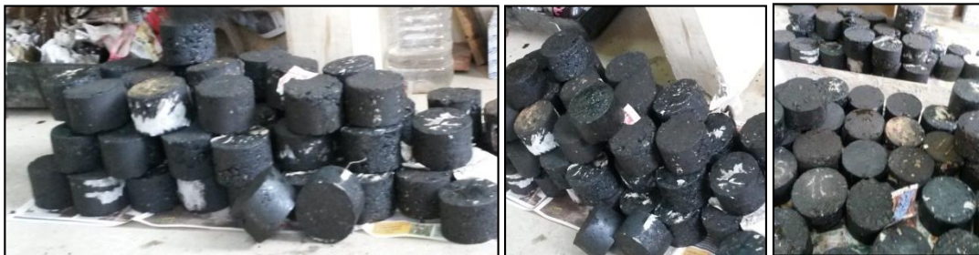
Imagen 56: Briquetas rotas mediante el ensayo Marshall
