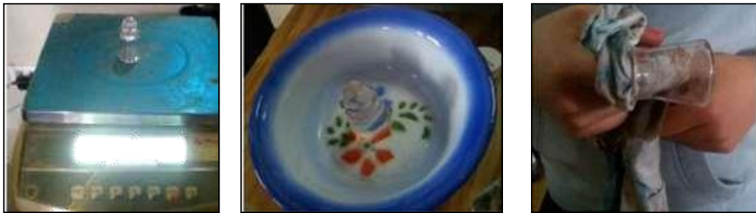
Imagen 29: Procedimiento de calibración del picnómetro
