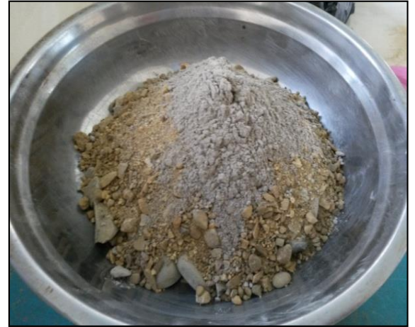
Imagen 46: Mezcla de agregado para la conformación de las mezclas asfálticas
