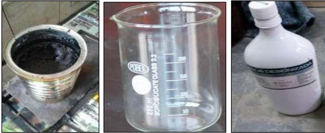
Imagen 28: Materiales usados durante el ensayo (Cemento asfáltico, picnómetro, agua destilada)
