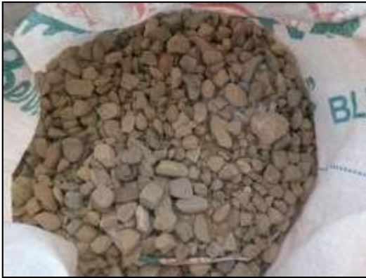
Imagen 16: Árido grueso expuesto en remojo durante 24 horas
