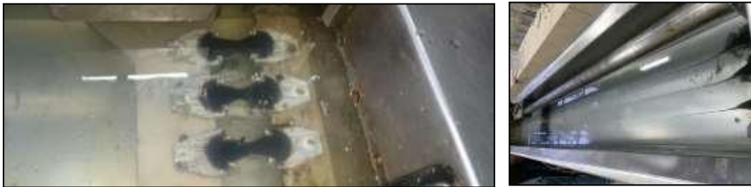
Imagen 36: Procedimiento de alargamiento de las muestras para determinar la ductilidad
