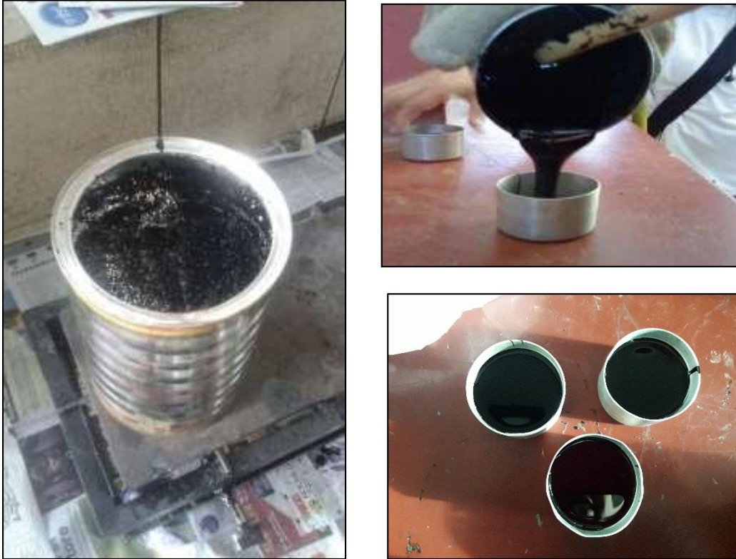
Imagen 31: Preparación de los especímenes de cemento asfáltico
