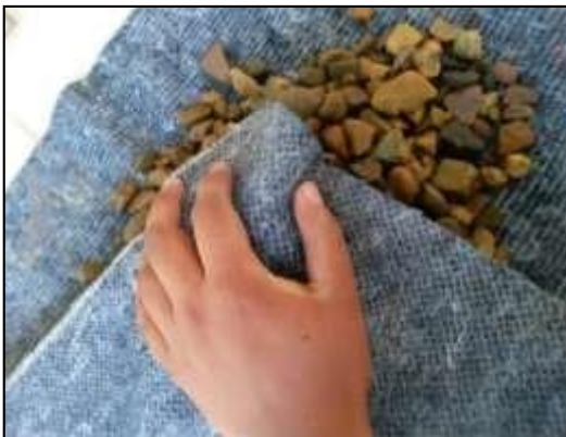
Imagen 17: Secado superficialmente del árido grueso
