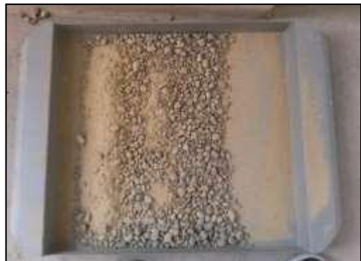
Imagen 16: Material resultante del desgaste
