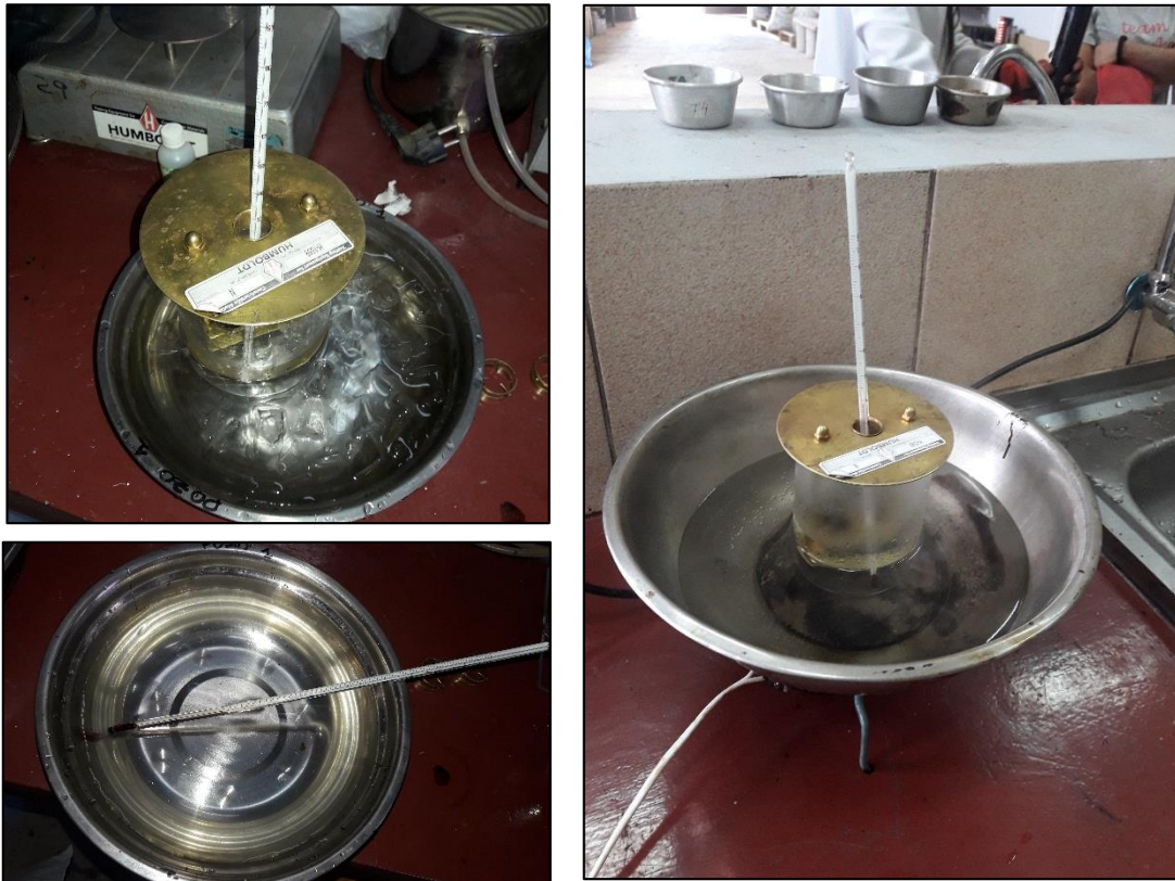
Imagen 40: Procedimiento del armado del aparato para el enfriado, y posterior lectura del termómetro para cada variación de temperatura
