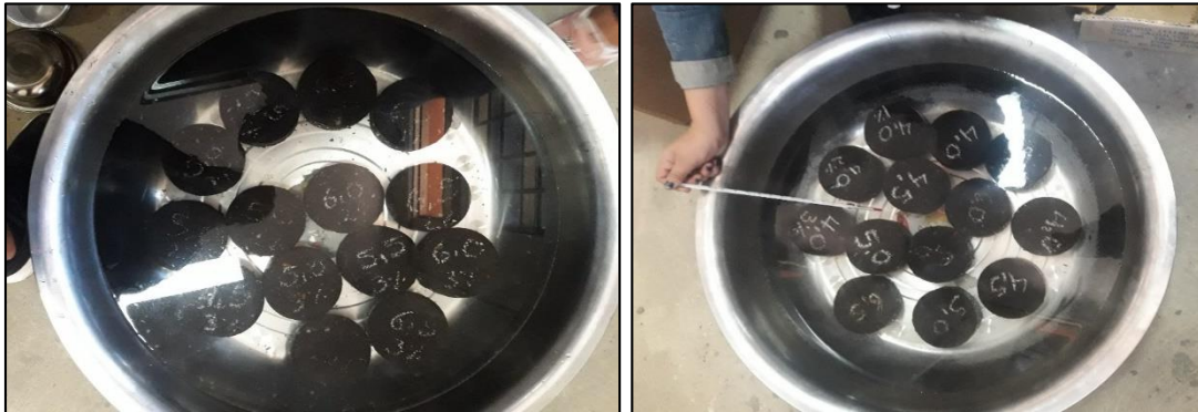
Imagen 54: Baño de agua de las briquetas a 60°C antes de la rotura
