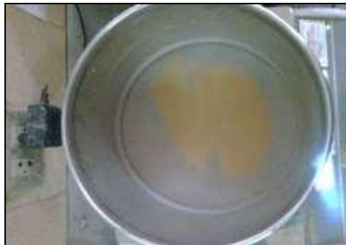
Imagen 7: Procedimiento de tamizado del agregado fino (arena)
