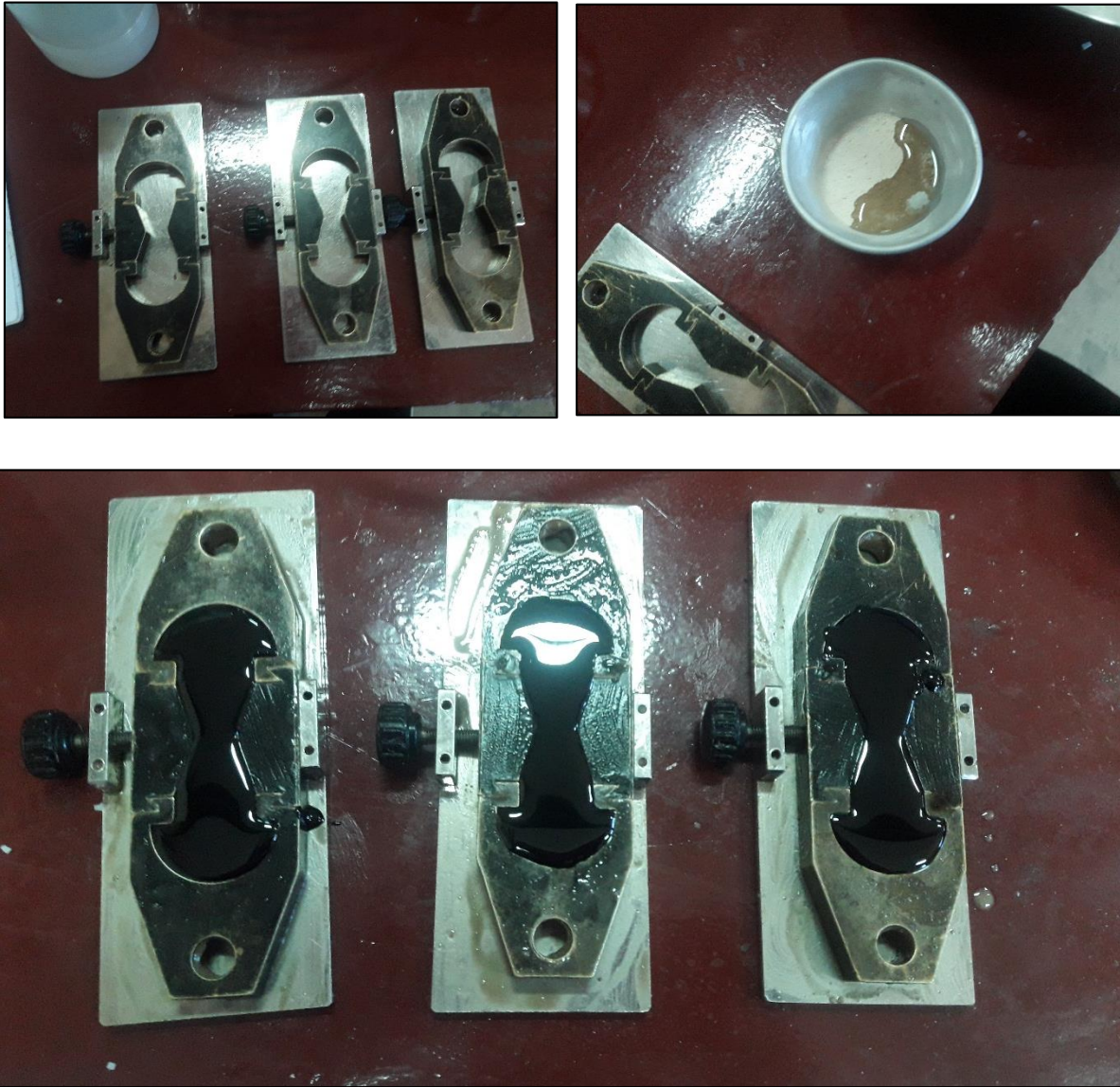
Imagen 37: Procedimiento de alargamiento de las muestras para determinar la ductilidad (Cemento asfáltico modificado con los diferentes porcentajes de cera de soya)
