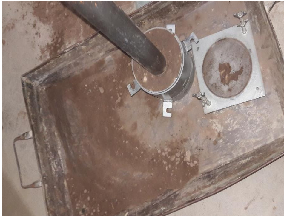
Imagen 8: Ensayo de compactación
