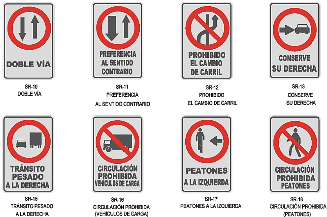
Figura 17: Ejemplo de señales reglamentarias
