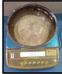
Imagen A.II.1. Muestra de suelo seca para realizar el lavado
