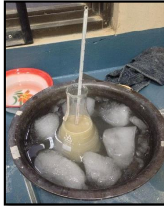
Imagen A.II.17. Medición de temperaturas de la mezcla de agua y suelo
