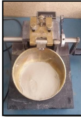
Imagen A.II.20. Disposición horizontal de la muestra sobre la taza
