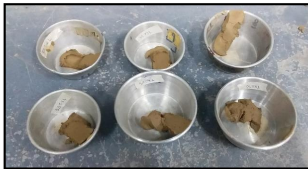
Imagen A.II.22. Porciones de muestras ensayadas a diferentes números de golpes
