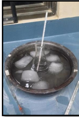
Imagen A.II.14. Calibración del frasco volumétrico
