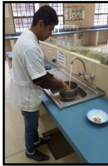
Imagen A.II.2. Lavado de la muestra a través del tamiz N° 200
