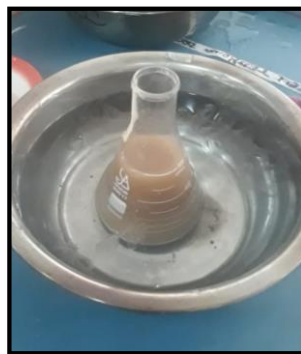
Imagen A.II.16. Frasco volumétrico más suelo sometido a baño María
