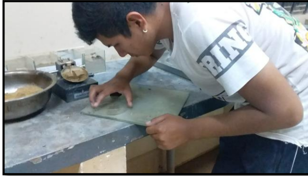
Imagen A.II.24. Formación de cilindros sobre la superficie de amasado
