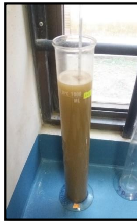
Imagen A.II.10. Medición de lecturas con hidrómetro 152 H
