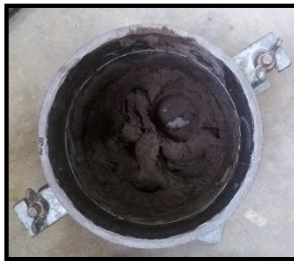
Imagen A.II.29. Proceso de compactación de la primera capa
