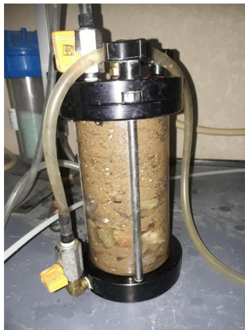
Figura 16 Permeámetro sin geotextil suelo de cobertura arenoso.
