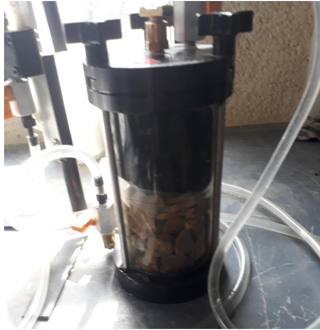
Figura 15 Permeámetro con geotextil suelo de cobertura arenoso.
