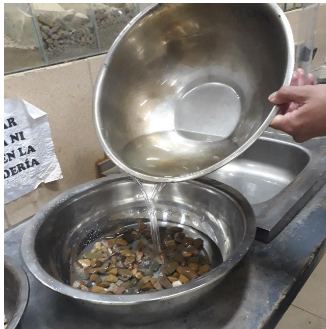
Figura 4 Vaciado de solución de sulfato al material granular de ensayo.
