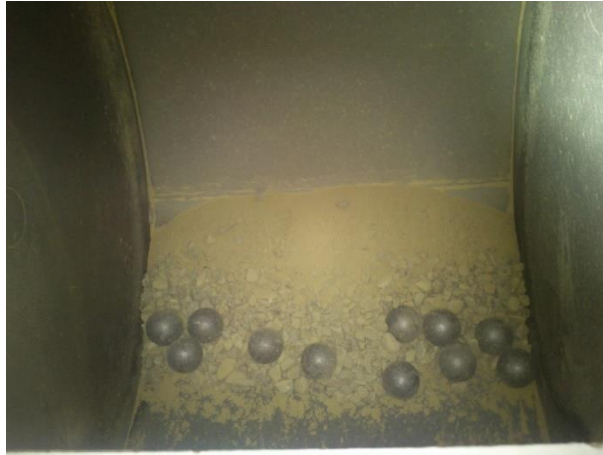
Figura 3.15. Muestra dentro de la máquina de los Ángeles Fuente: Fotografía propia
