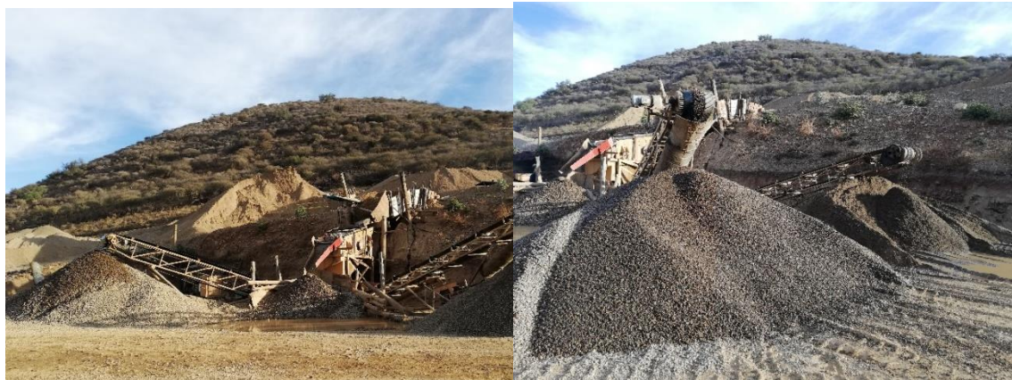
Figura 3.1. Clasificadora Construcción Presa Sella Rumicancha Fase I Agregado Grueso Fuente: Fotografía propia
