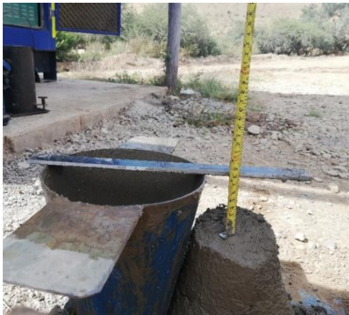
Figura 3.32. Asentamiento hormigón con 30% de vinaza 7,8 cm Fuente: Fotografía propia
