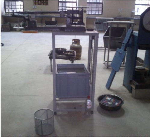
Figura 3.8. Equipo para el pesado de la muestra sumergida Fuente: Fotografía propia
