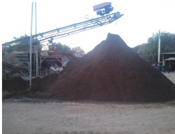
Figura 2.2. Acopio de arena clasificada Fuente: Fotografía propia
