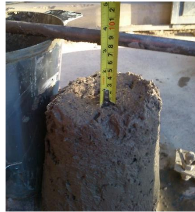
Figura 3.26. Asentamiento ensayo cono de Abrams Fuente: Fotografía propia
