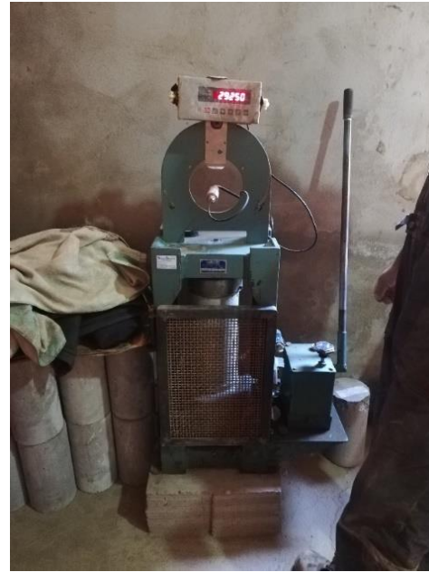
Figura 3.31. Prensa SOCOTEC – Laboratorio "Construcción Presa Sella Rumicancha fase I" Fuente: Fotografía propia
