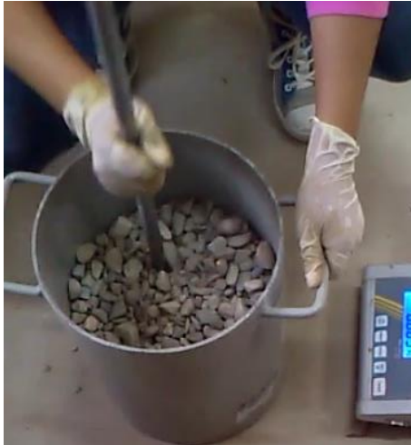
Figura 3.12. Apisonado con varilla 2da capa
