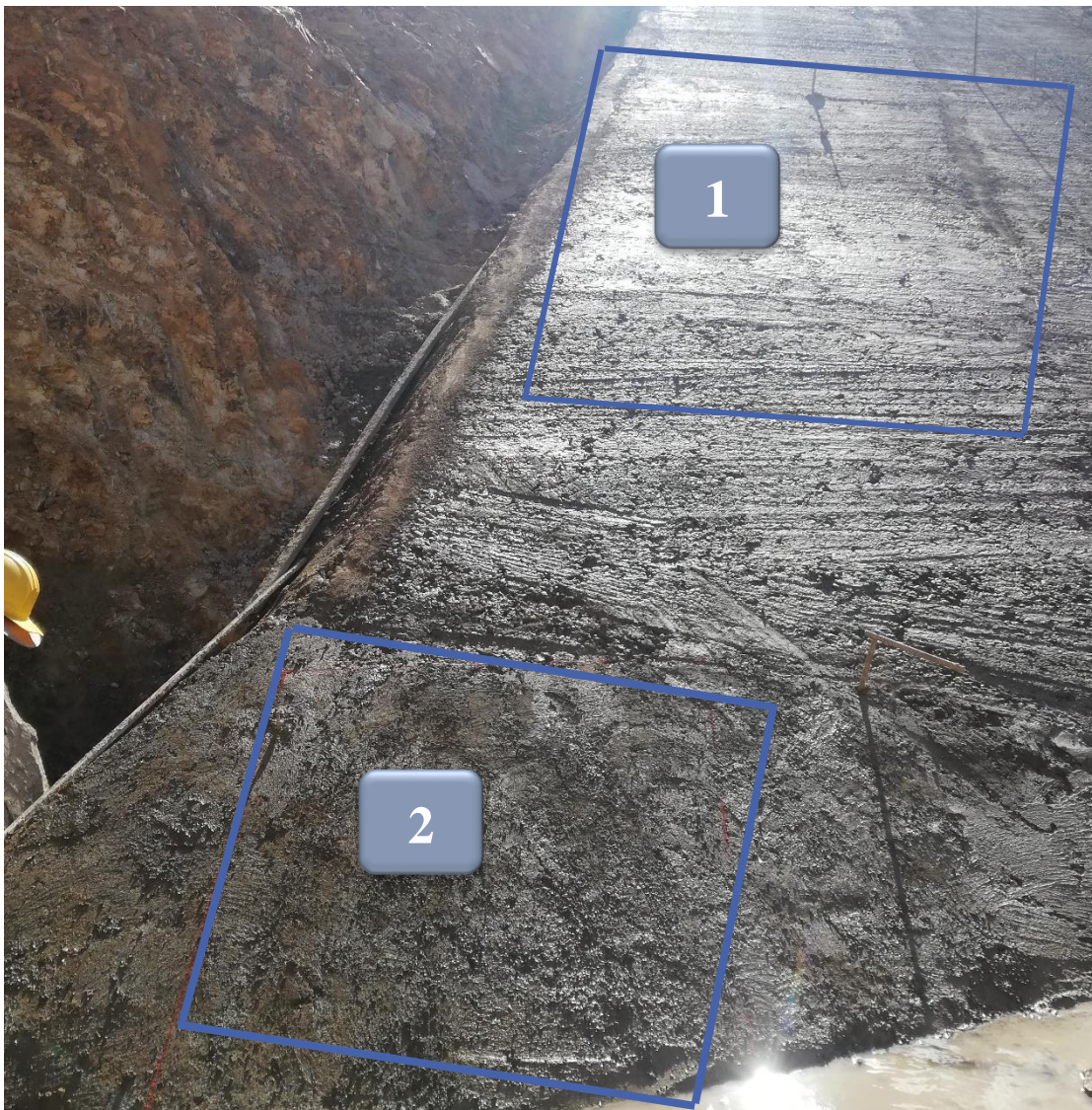
Figura 3.36. Secciones de monitoreo a 4 hrs. después del hormigonado, sección 1 hormigón H-21; Sección 2 hormigón 30% inclusión de vinaza Fuente: Fotografía propia
