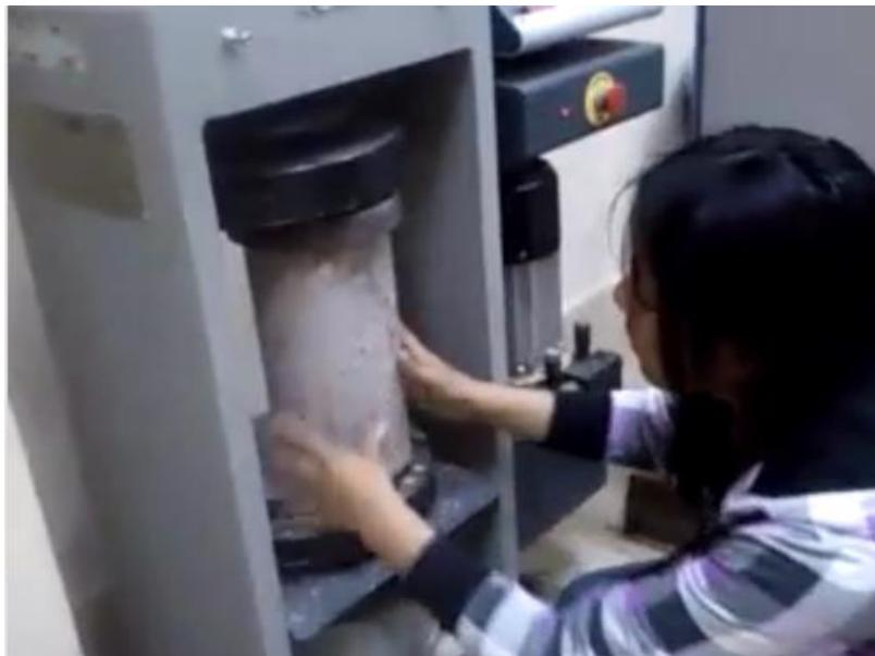
*Figura E.18. Colocado molde cilíndrico en prensa*
