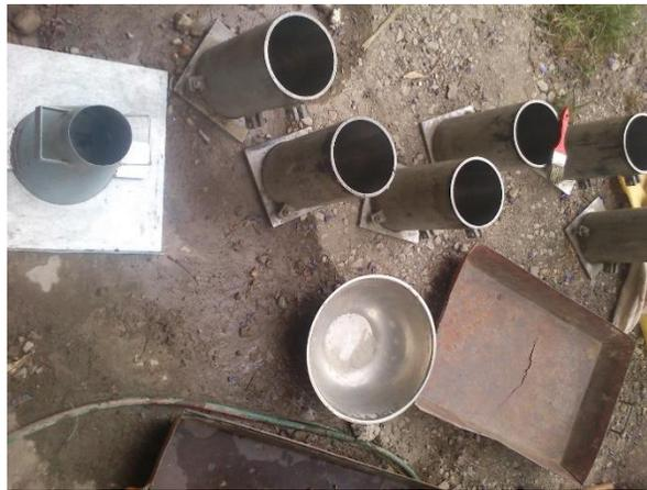
*Figura E.2. Cono de Abrahams y moldes cilíndricos*
