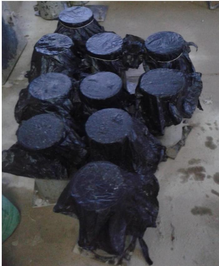
**Figura E.12.** Reposo de 24 horas antes del desmoldado
