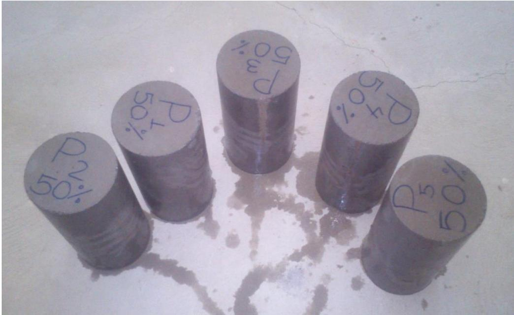
**Figura E.15.** Reposo para secado antes de la rotura
