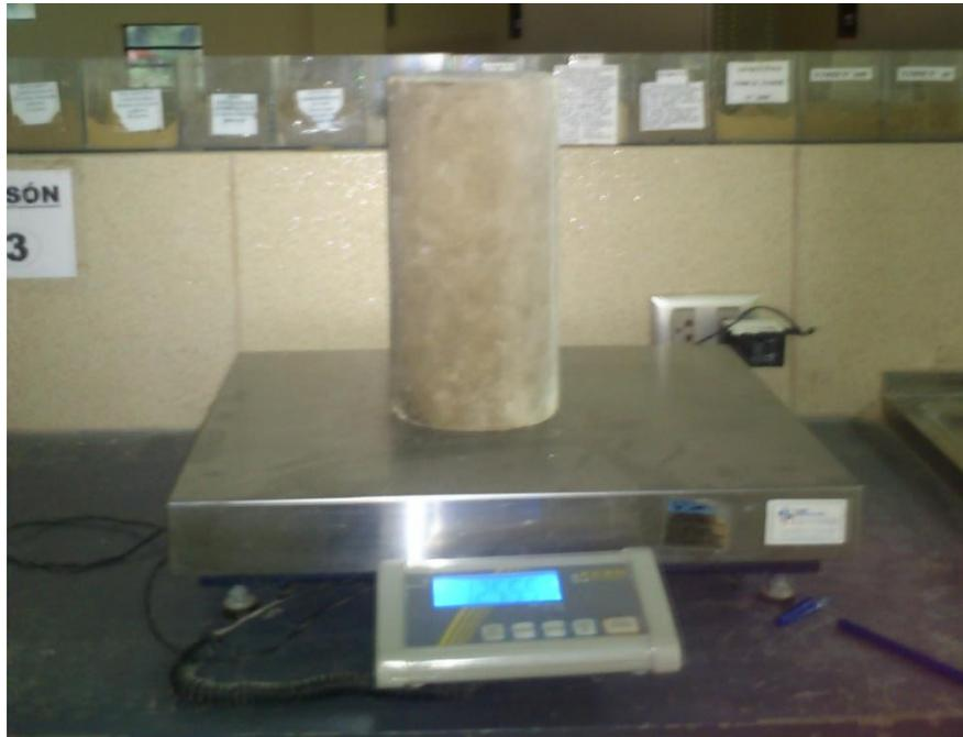
*Figura E.17. Pesado de probeta*
