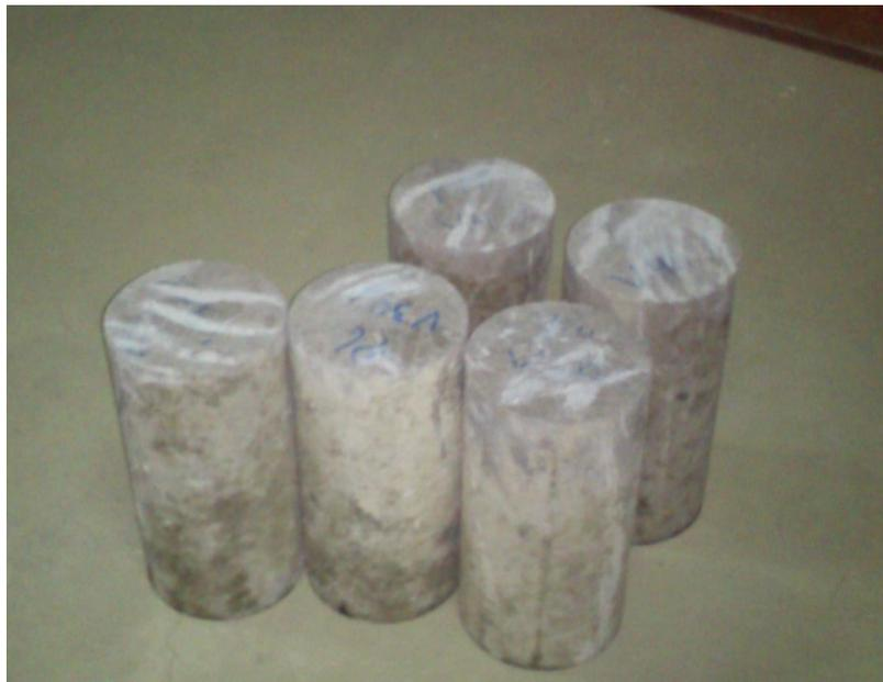
**Figura E.16.** Muestras secas para el pesado y el ensayo a compresión
