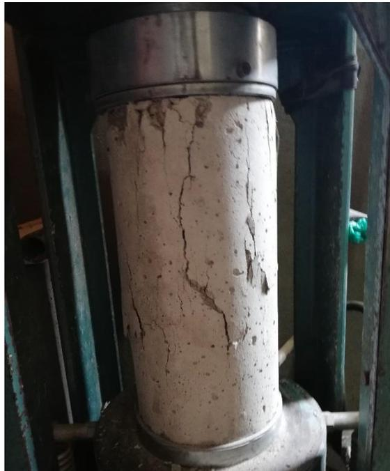
*Figura E.36. Falla a compresión hormigón vinaza al 30%
