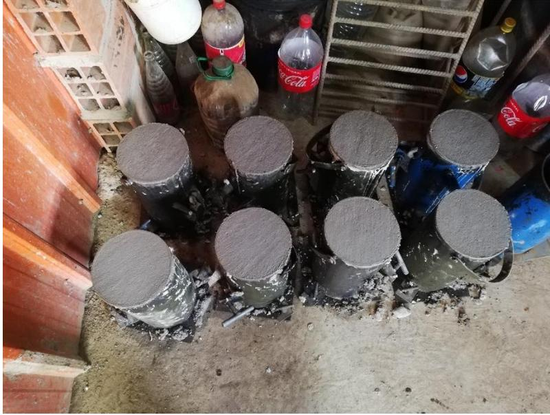
**Figura E.31.** Muestras hormigón H-21 y Hormigón con vinaza 30%
