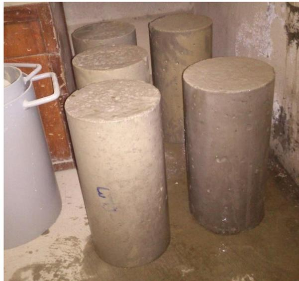
*Figura E.14. Muestras después de 7 días sumergidas en la piscina*
