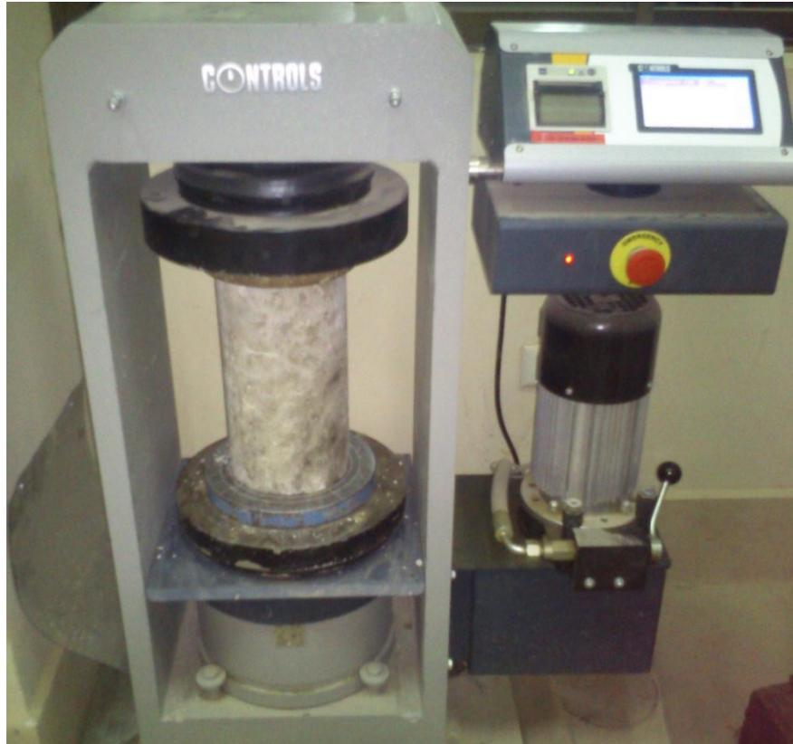
*Figura E.19. Inicio del ensayo a compresión
