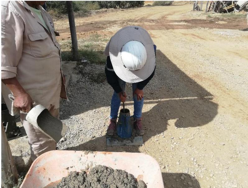
**Figura E.28.** Ensayo de asentamiento mediante cono de Abrams
