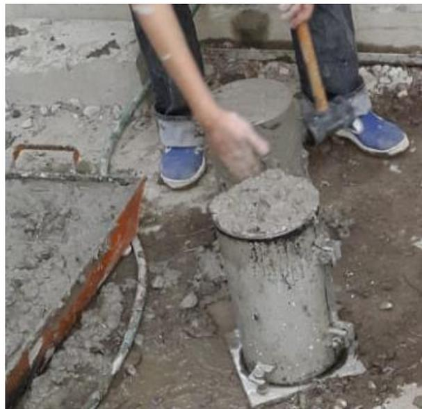
*Figura E.10. Extracción de aire atrapado mediante mazo neumático*
