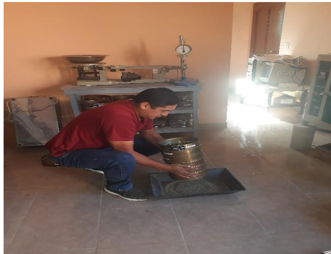
Figura 23. Análisis granulométrico de los suelos (tamizado).
