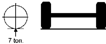
Figura 1. Peso admisible de eje simple 2 neumáticos de 7000 Kg.
