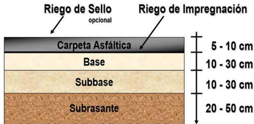
Figura 6. Sección transversal del pavimento flexible.
