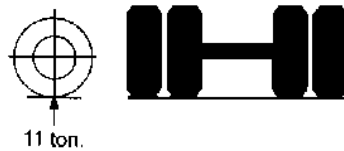
Figura 2. Peso admisible eje simple de 4 neumáticos es de 11000 Kg.
