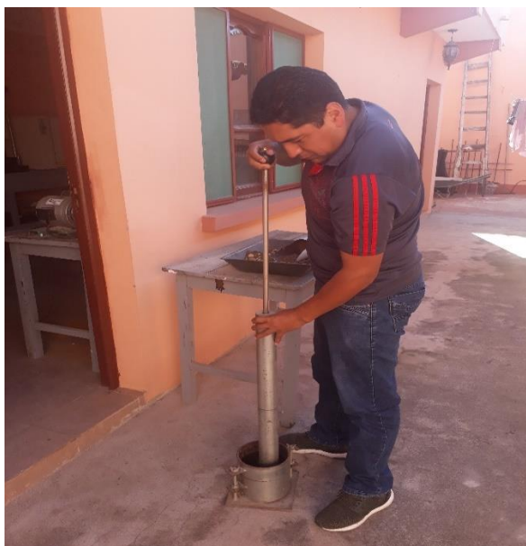
Figura 25. Compactacion del suelo.
