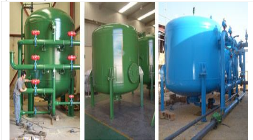
Figura 2.22 Tipos de Filtros (filtro de arena).-
