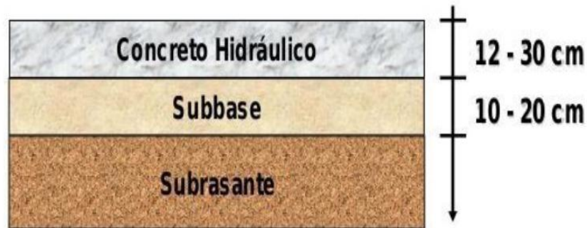
Figura 2.7 Sección transversal pavimento rígido
