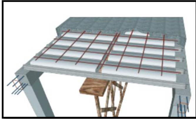
Figura N° 3.22 Riostras Transversales en Losas Alivianadas
