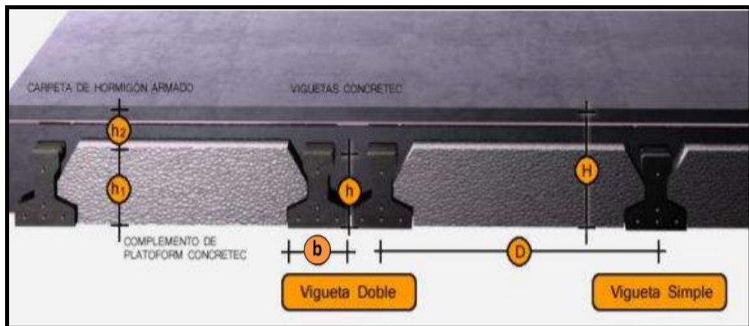
Figura N° 2.6 Geometría de losa alivianada
