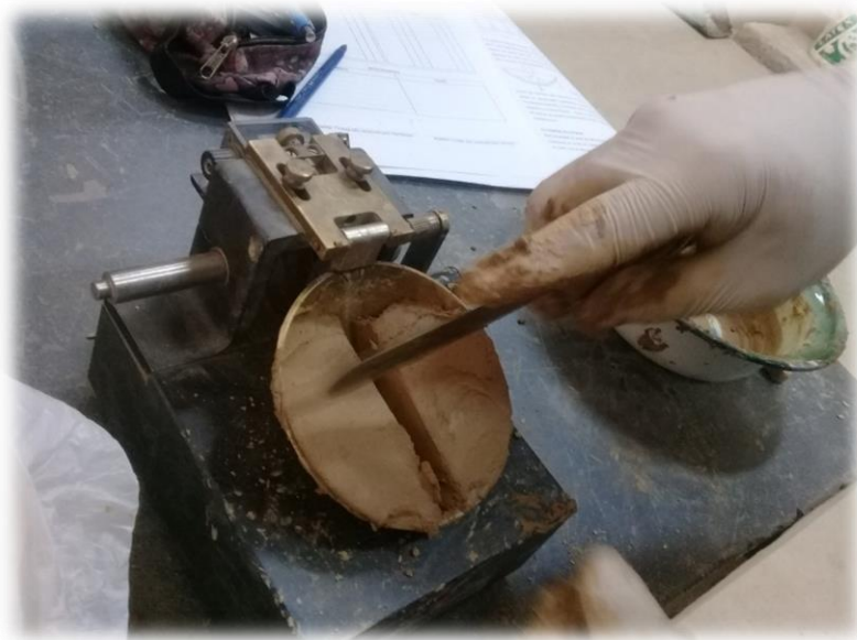
Imagen 1 Copa de Casagrande, dispositivo de límite líquido.
