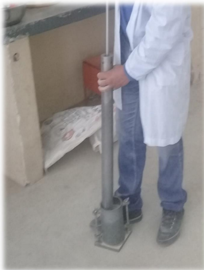
Imagen 4 Equipo para la prueba proctor estándar
