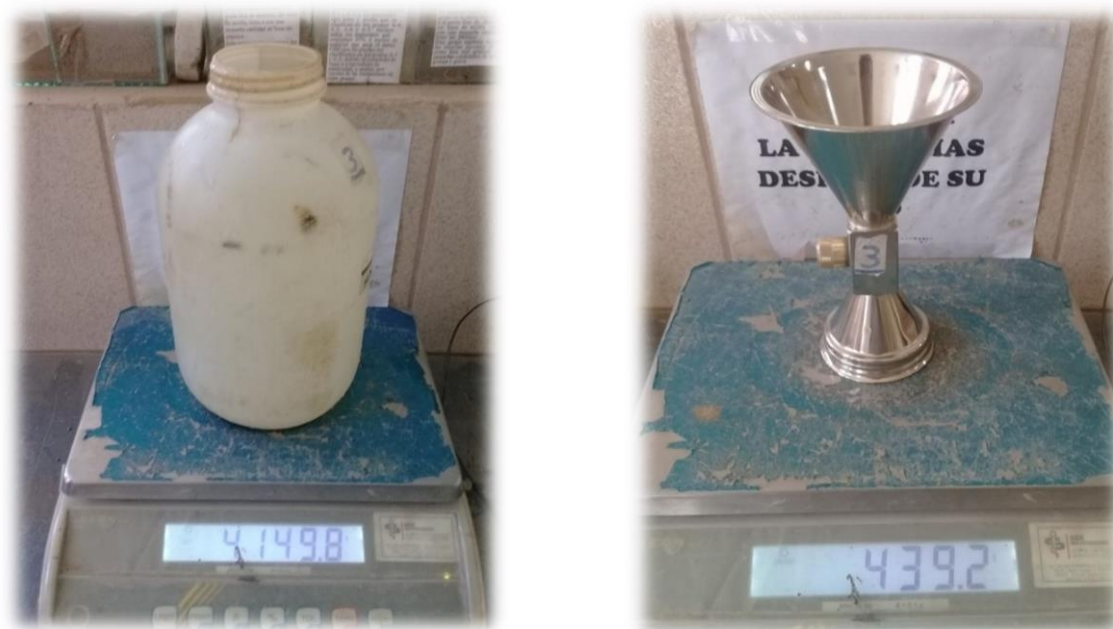
Imagen 10 Calibración del equipo para densidad in situ
