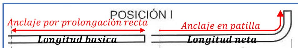
*Ilustración de anclaje en barras corrugadas en posición I [Figura]. Recuperado de <http://todoedificacion.blogspot.com/2012/03/anclaje-de-armaduras.html>*
