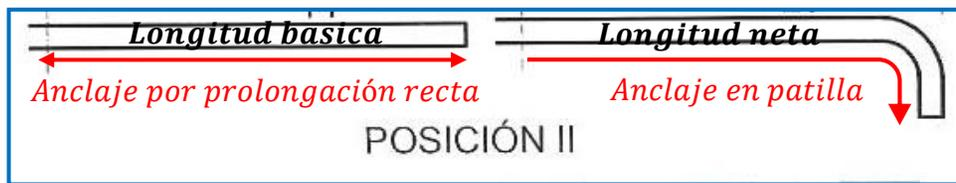
*Ilustración de anclaje en barras corrugadas en posición II [Figura].* Recuperado de <http://todoedificacion.blogspot.com/2012/03/anclaje-de-armaduras.html>
