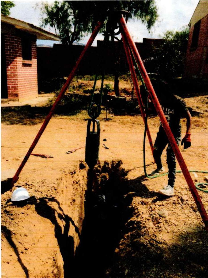
Preparación del ensayo de Penetración Estándar STP
