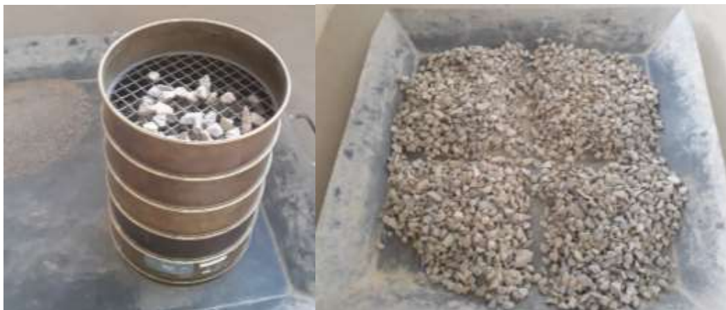
Figura 3.4. Proceso de tamizado del agregado grueso
