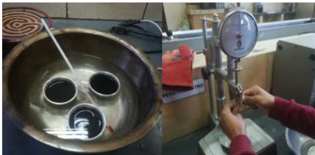
Figura 3.12. Penetración de la muestra
