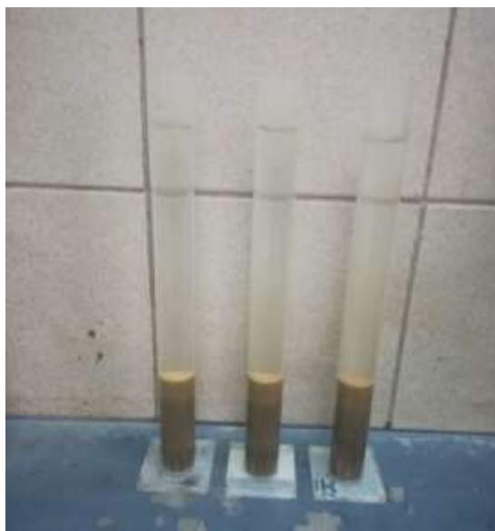
Figura 3.10. Mezcla de la arena con la solución para el equivalente de arena
