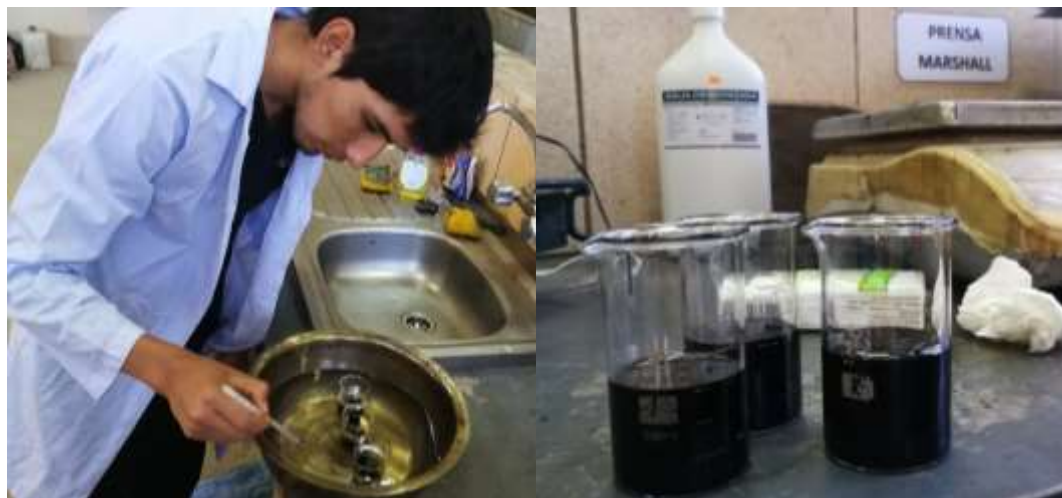
Figura 3.14. Picnómetro más muestra a 25 °C
