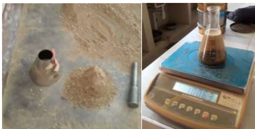
Figura 3.8. Determinando el peso específico de la arena
