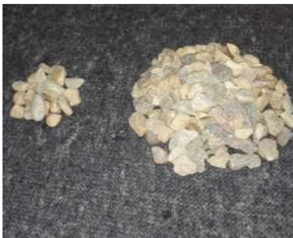
Figura 3.11. Ensayo del porcentaje de caras fracturadas de los agregados
