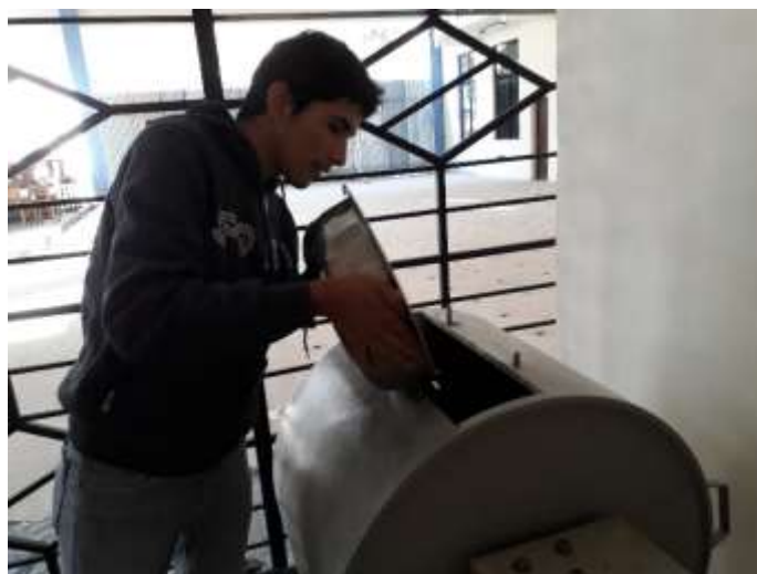
Figura 3.5. Proceso del ensayo de desgaste por medio de la máquina de los Ángeles
