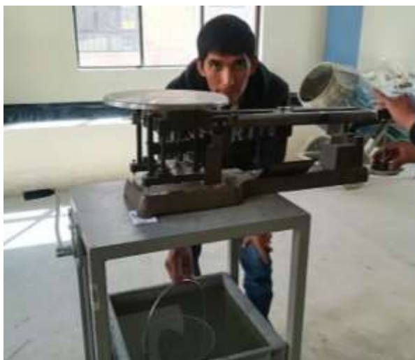
Figura 3.7. Proceso del peso sumergido
