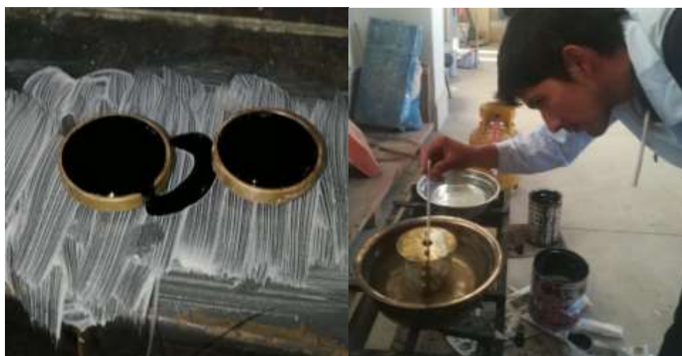
Figura 3.15. Muestra calentando a baño María
