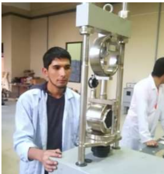
Figura 4.4. Ensayo Marshall de estabilidad y fluencia
