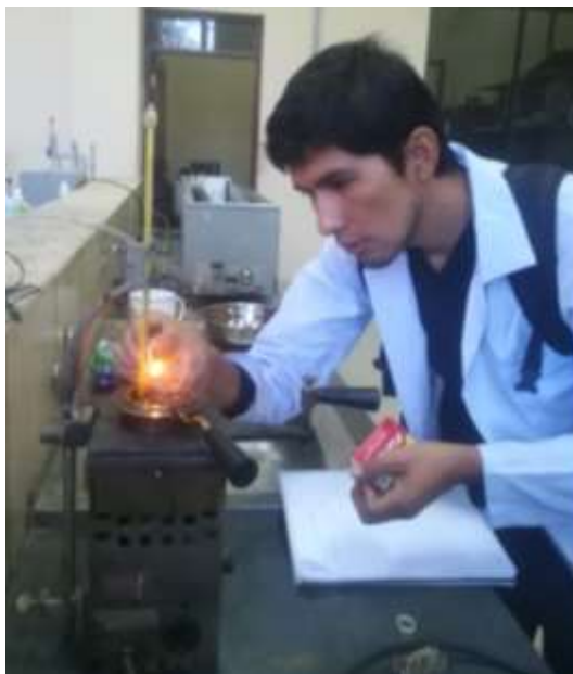
Figura 3.13. Punto de inflamación en proceso de ensayo
