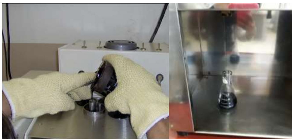
Figura 3.17. María Ensayo viscosidad Saybolt Furol
