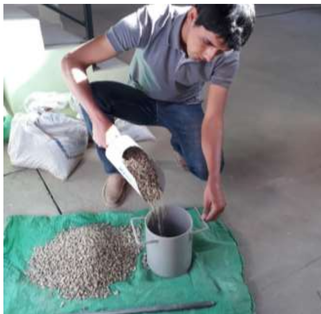
Figura 3.9. Realizando el ensayo de peso unitario del agregado 3/8”
