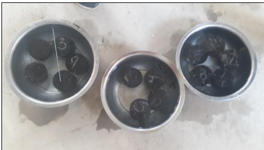
Fotografía 4.3: Briquetas en baño maría a temperatura de 25 °C
