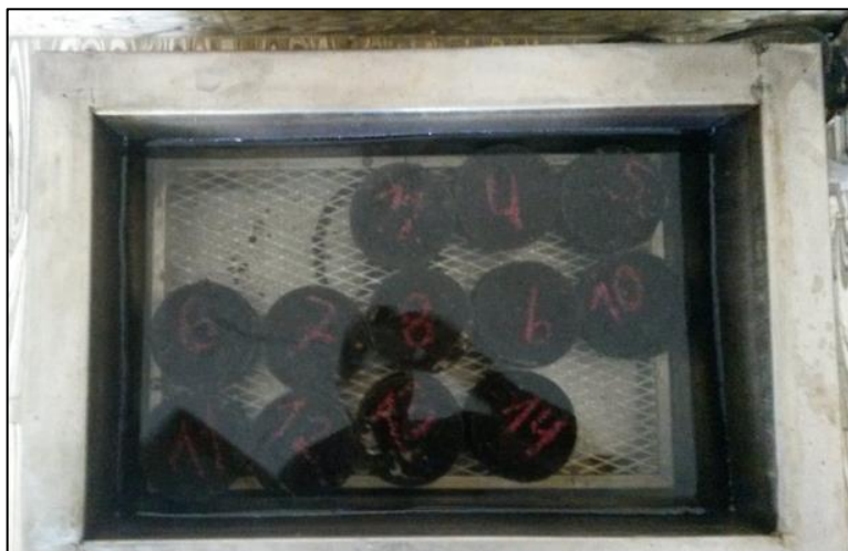
Fotografía 4.4: Briquetas en baño maría a temperatura de 60 °C
