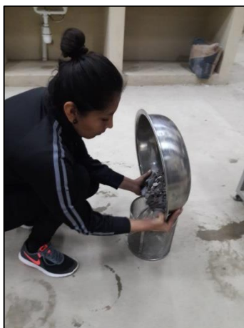
Fotografía 3.11: Vertido del agregado grueso en la canastilla metálica
