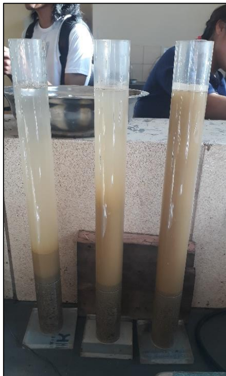
Fotografía 3.1: Observación del ensayo de equivalente de arena y agregado fino
