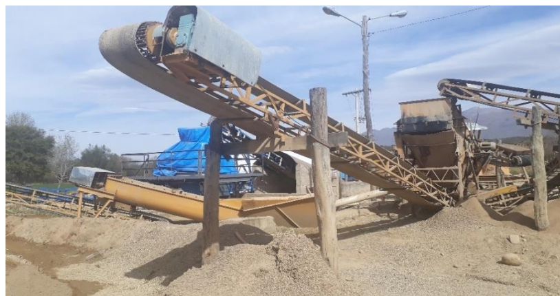
Fotografía 3.3: Bandas transportadoras del agregado
