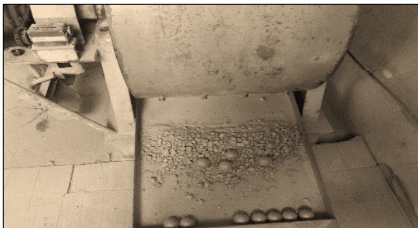
Fotografía 3.13: Material granular listo para tamizar en el tamiz N°12
