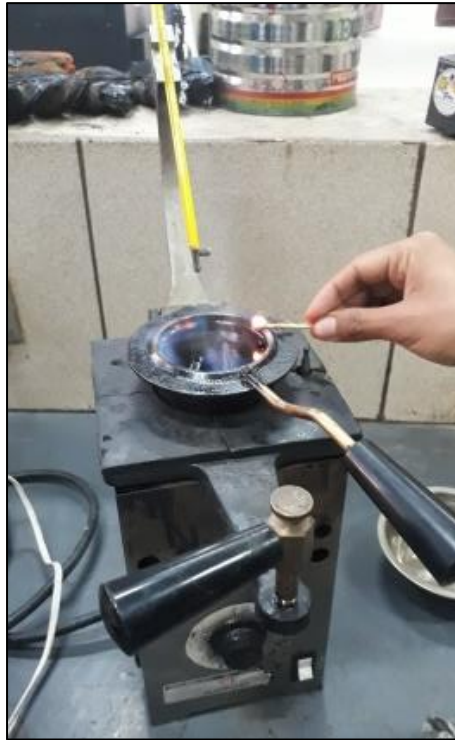
Fotografía 3.16: Calentado la muestra para el punto de inflamación
