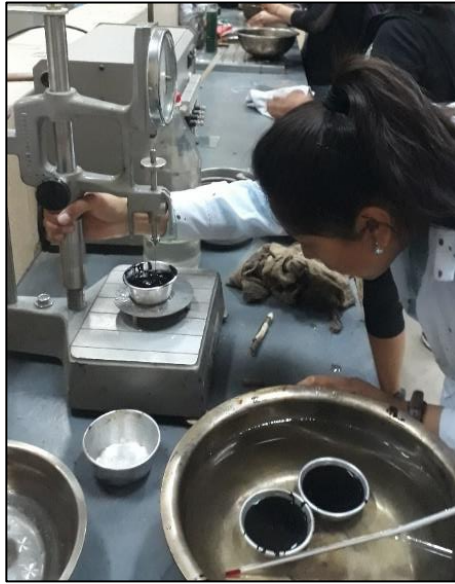
Fotografía 3.17: Penetración de la muestra
