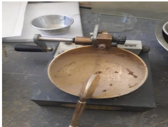
Figura 8. Ensayo de limite líquido
