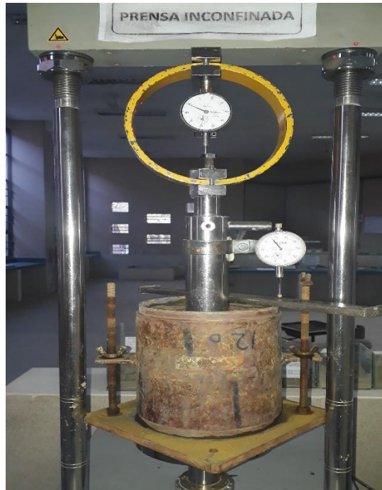
Figura 10. Ensayo de CBR
