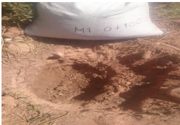
Figura 6. Extracción de muestras de suelo
