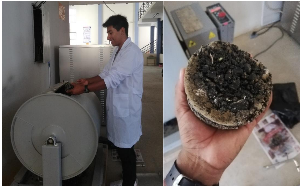
Imagen 4. 7. Ensayo de cántabro seco y húmedo
