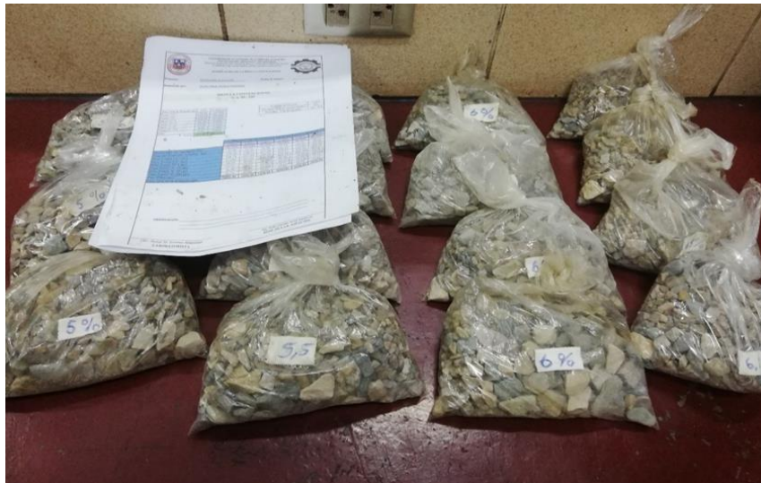
Imagen 4. 1. Dosificación para las mezclas asfálticas porosas
