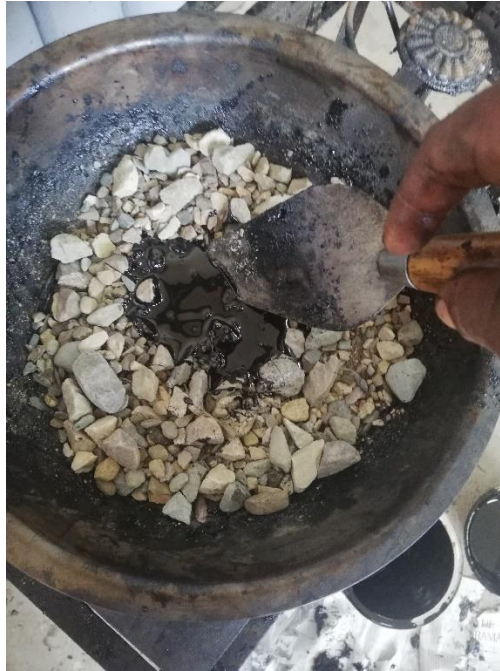
Imagen 4. 2. Mezclado de los agregados con el cemento asfáltico
