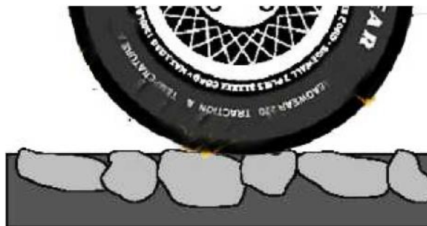
Figura 2. 9. Macrotextura de pavimento
