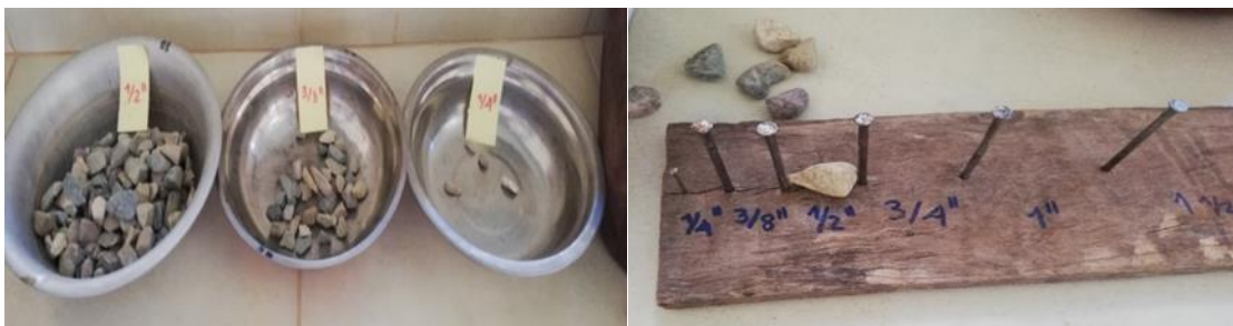
Imagen 3. 4. Ensayo de índice de aplanamiento de agregados
