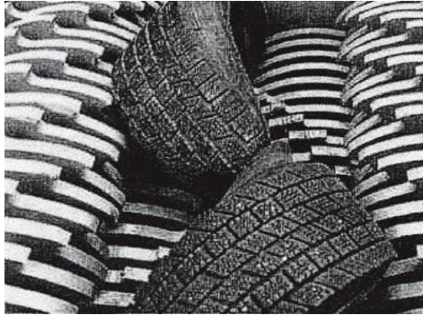
Figura 2. 12. Trituración mecánica por acción de cuchillas
