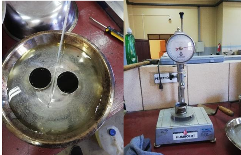
Imagen 3. 11. Ensayo de penetración del cemento asfáltico
