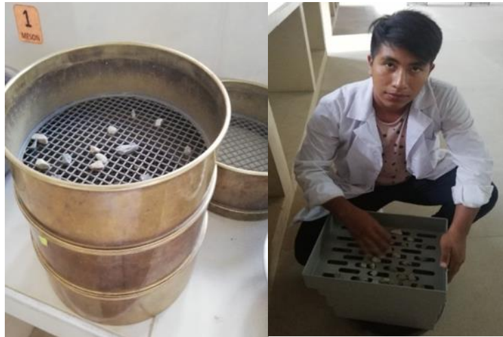
Imagen 3. 3. Ensayo de aplanamiento de los agregados
