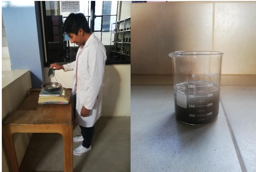
Imagen 3. 10. Ensayo peso específico del filler
