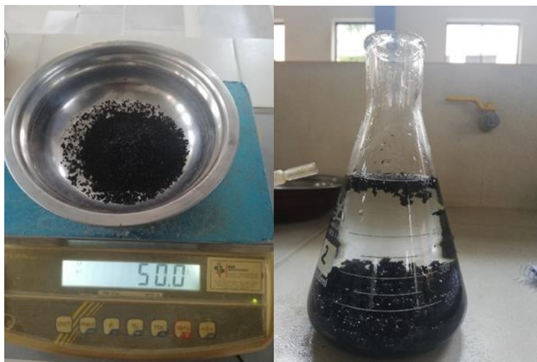
Imagen 3. 17. Ensayo peso específico del caucho reciclado
