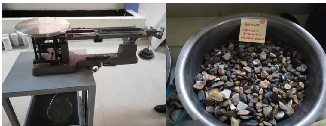
Imagen 3. 8. Ensayo de peso específico del agregado grueso
