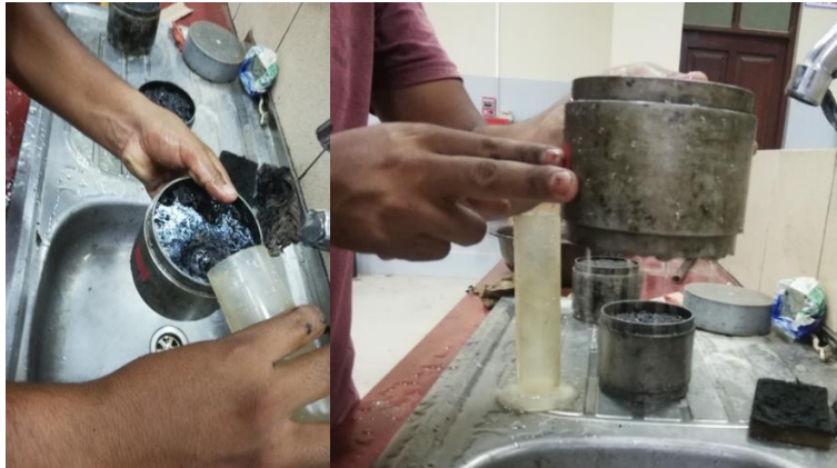
Imagen 4. 6. Medición de la permeabilidad
