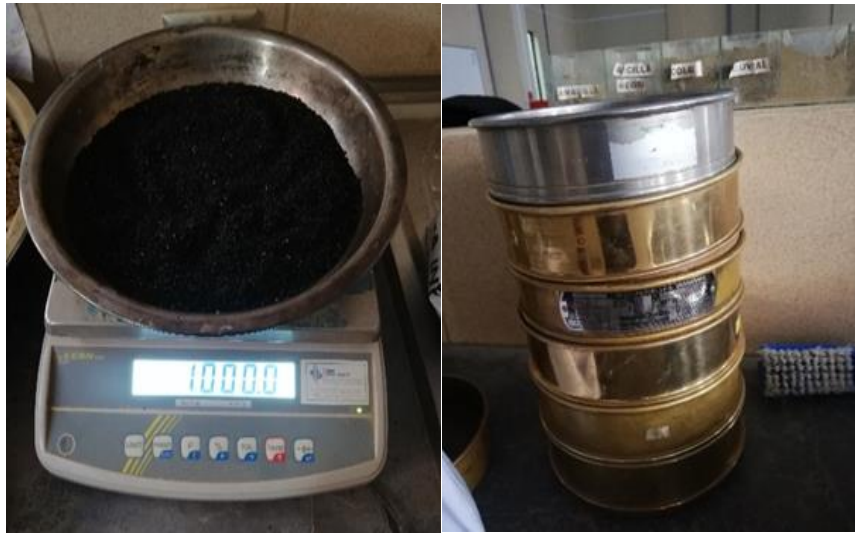
Imagen 3. 16. Granulometría del grano de caucho reciclado
