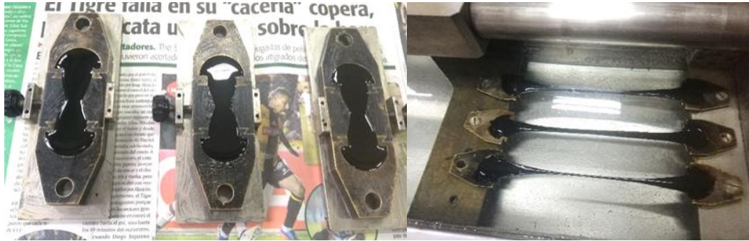
Imagen 3. 14. Ensayo de ductilidad del cemento asfáltico
