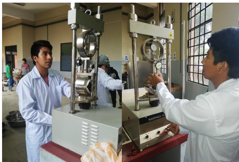
Imagen 4. 8. Ensayo de estabilidad y fluencia
