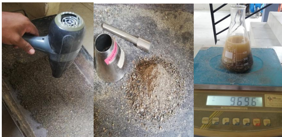
Imagen 3. 7. Ensayo de peso específico del agregado fino
