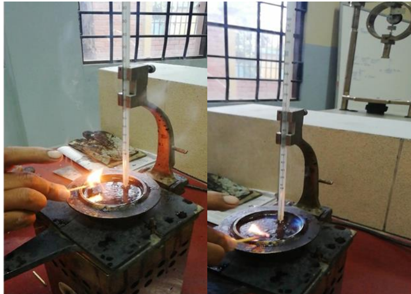
Imagen 3. 12. Ensayo de punto de inflamación del cemento
