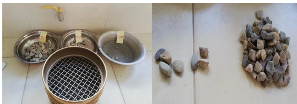
Imagen 3. 5. Ensayo de caras fracturadas de los agregados
