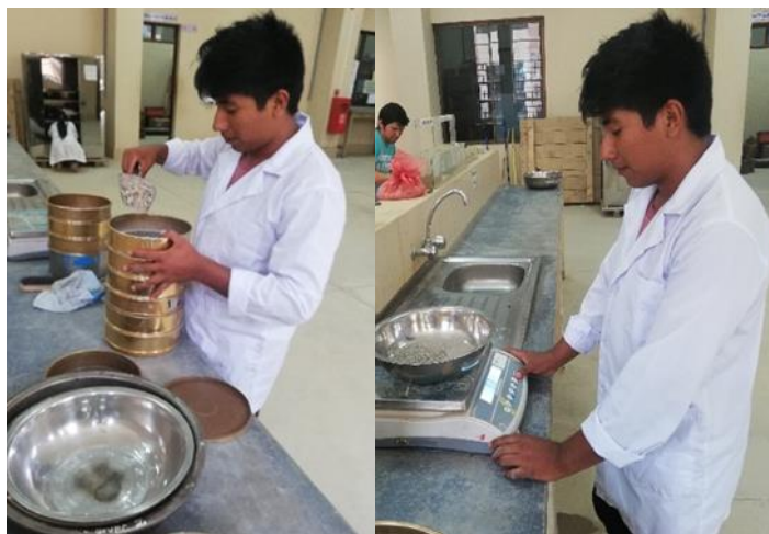
Imagen 3. 2. Ensayo de granulometría del agregado grueso y fino
