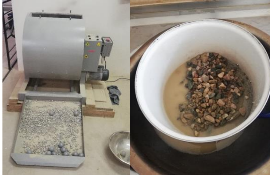
Imagen 3. 6. Ensayo de abrasión de agregado grueso
