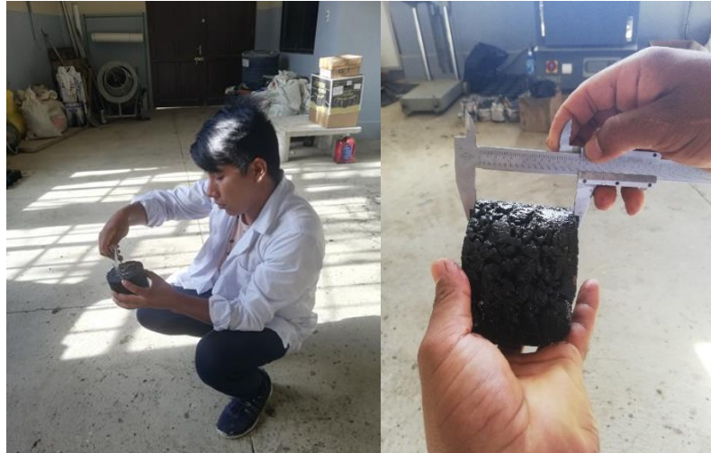
Leyenda: Medición de diámetro y alturas de las briquetas
