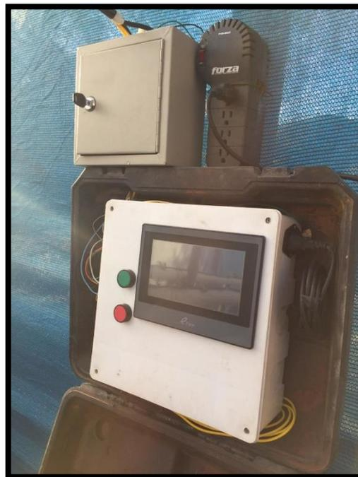
**Fotografía A.6.15. Entradas de conexión de los sensores de humedad**
