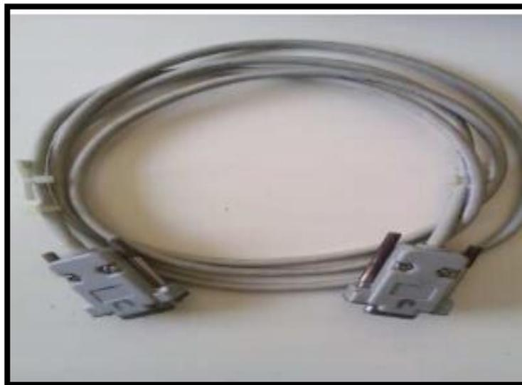
El cable llevará la configuración entre el PLC y el HMI.
