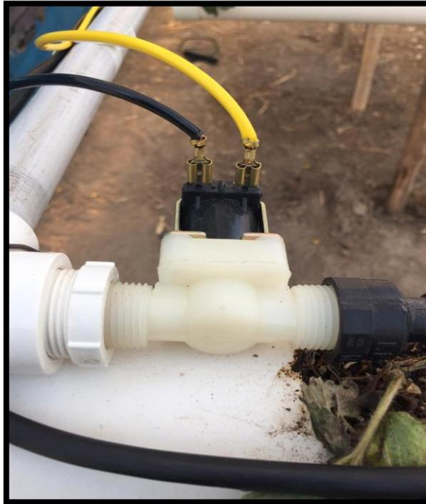
Fotografía A.6.6. Conexión del sensor de flujo de agua
