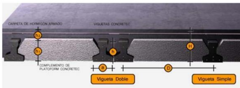
Gráfico 3.17. Sistema de Aplicación de la Vigüeta Pretensada Fuente: Ficha Técnica Vigüetas Pretensadas CONCRETEC
