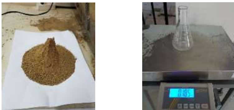
Imagen 3.2:5. Humedad óptima de la arena y peso del matraz para el ensayo
