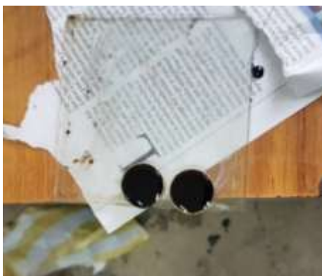
Imagen 3.2:19. Vaciado de asfalto en moldes
