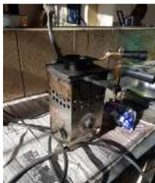
Imagen 3.2:17.Cocinilla especial para calentar el C.A. y medir temperatura de inflamación
