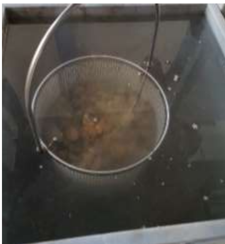
Imagen 3.2:4. Pesado del peso sumergido del agregado
