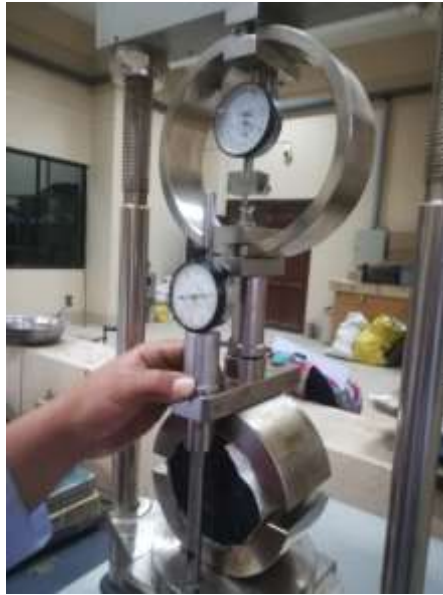
Imagen 4.4:3. Medición de la estabilidad y la fluencia Marshall
