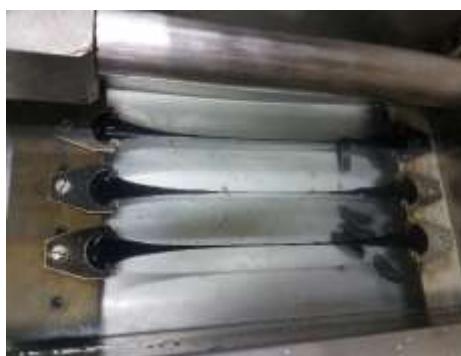
Imagen 3.2:25. Medición de la ductilidad del cemento asfáltico
