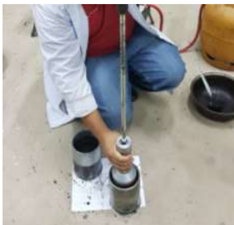
Imagen 4.2:4. Compactación con martillo Marshall
