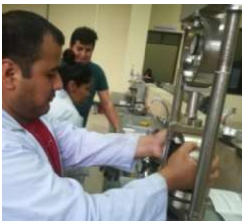
Imagen 4.2:6. Colocado de briqueta en el Marshall para lectura de la estabilidad y fluencia.
