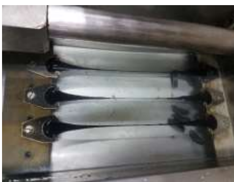
Imagen 3.2:25. Medición de la ductilidad del cemento asfáltico
