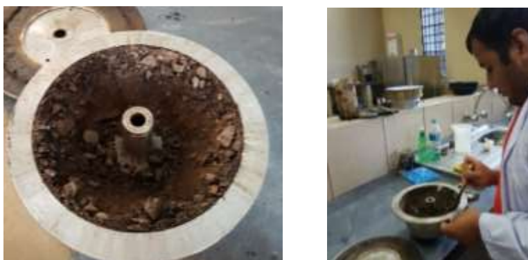
Imagen 3.3:2. Retiro del material del extractor centrífugo
