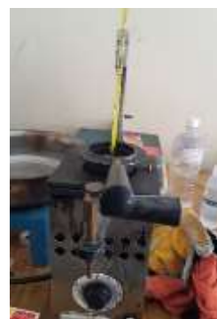
Imagen 3.2:17.Cocinilla especial para calentar el C.A. y medir temperatura de inflamación
