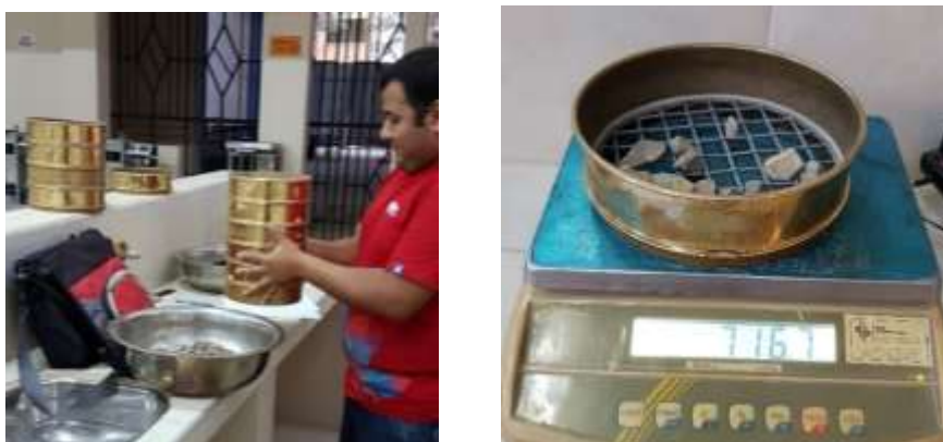
Imagen 3.2:2. Tamizado del agregado para luego pesar lo retenido en cada tamiz
