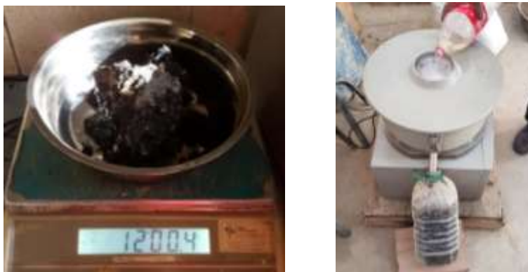
Imagen 3.3:1. Pavimento reciclado peso para depositar en el extractor centrífugo
