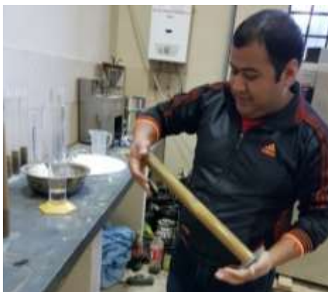
Imagen 3.2:11. Agitación de la mezcla para evitar vacíos de aire
