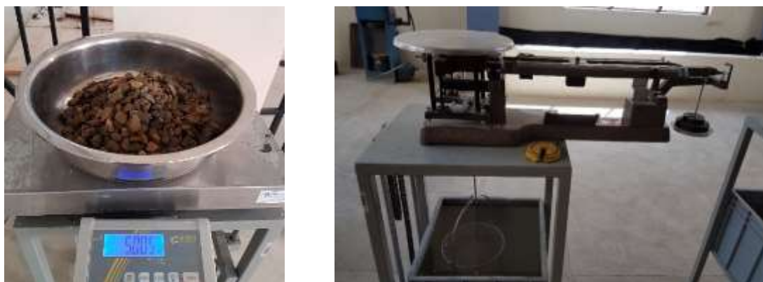
Imagen 3.2:3. Pesado de muestra en balanza para el peso sumergido del agregado
