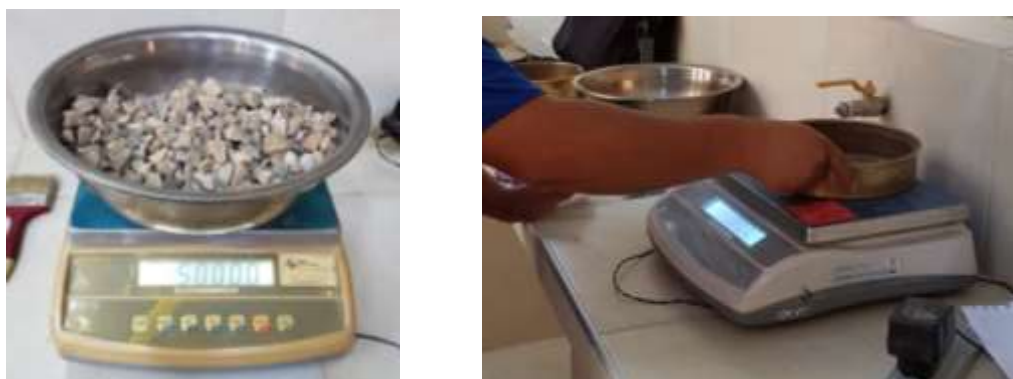
Imagen 3.2:1. Pesado del agregado más los pesos de cada tamiz
