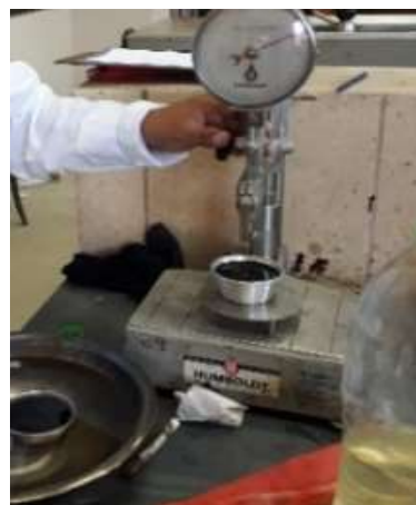
Imagen 3.2:16. Medición de la penetración
