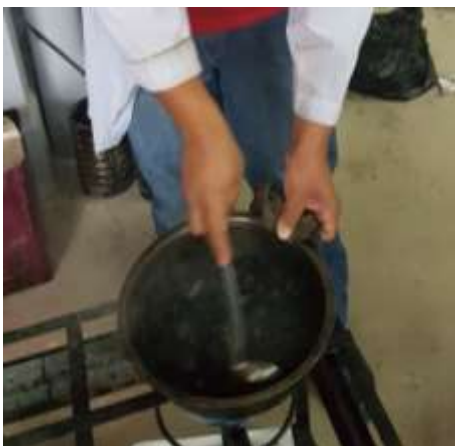
Imagen 4.2:3. Mezcla de los materiales a más de 140 °C y compactación con el martillo Marshall a 75 golpes
