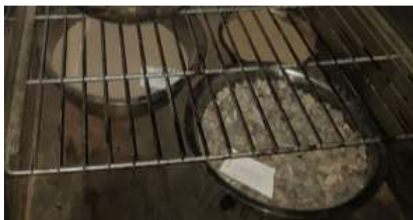
Imagen 4.2:2. Calentamiento de agregados en el horno
