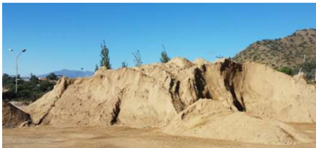
Imagen 3.1:3. Arena acopiada para las mezclas asfálticas
