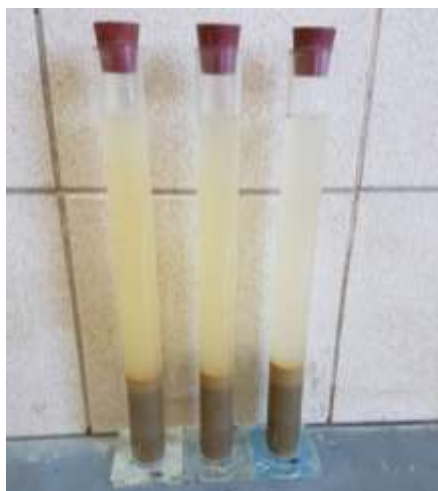
Imagen 3.2:12. Arena total mente asentada para medir su altura
