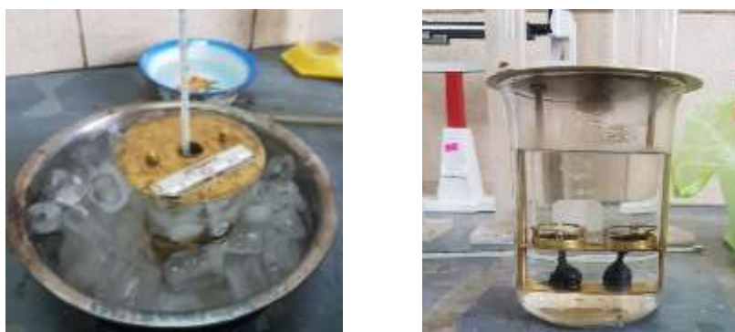
Imagen 3.2:20. Enfriamiento del cemento asfáltico para luego calentar.
