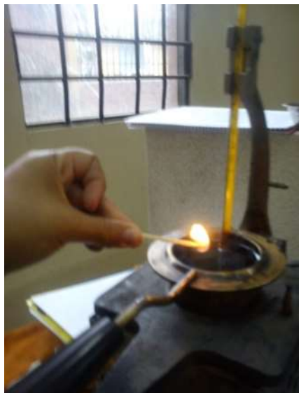
Imagen 3.3:13 Calentamiento para el punto de inflamación
