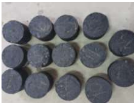
Imagen 4.2:5. Briquetas elaboradas para realizar el baño maría a 60 °C para luego colocar en el anillo Marshall
