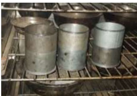
Imagen 4.2:1. Calentamiento de moldes y agregados en el horno
