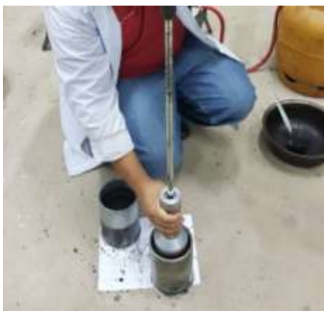
Imagen 4.2:4. Compactación con martillo Marshall
