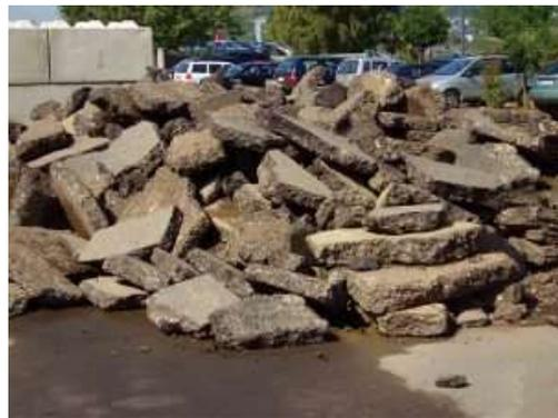
Los agregados obtenidos mediante la disgregación de una mezcla asfáltica de un pavimento existente no deberán mostrar signos de meteorización, y su calidad deberá ser similar a la exigida para los agregados de adición.
