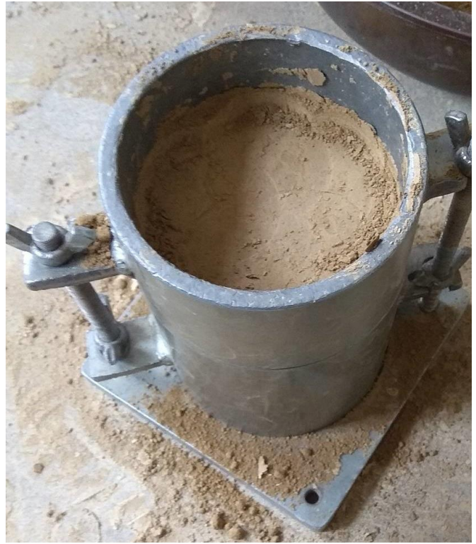
Foto N°6: Compactación de suelo molde T-99
