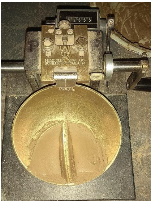
Foto N°3: Aparato Casagrande para el LL.
