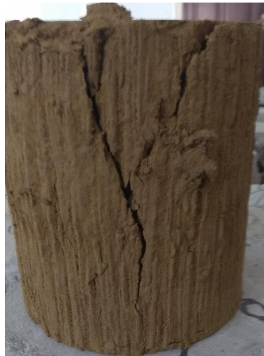
Foto N°9: Rotura de probeta solo suelo N°2
