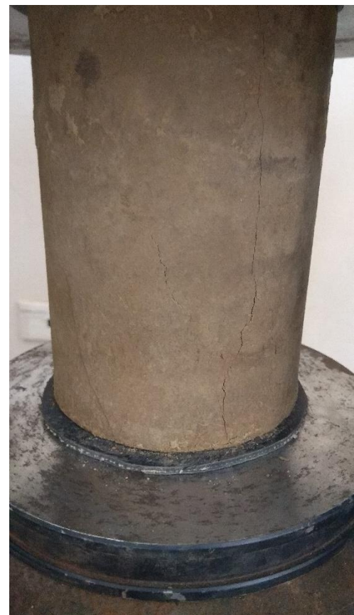
Foto N°14: Rotura de probeta S-C al 8%
