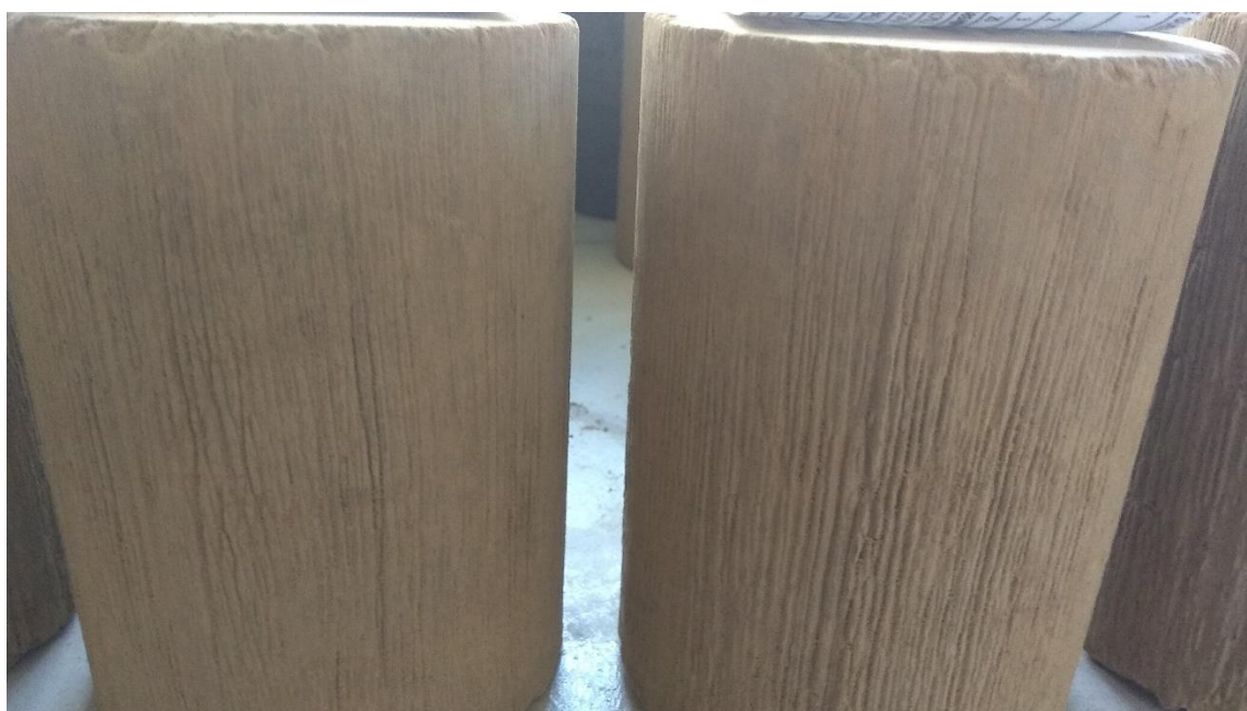
Foto N°15: Desgaste de probetas S-C al 8% método de raspado
