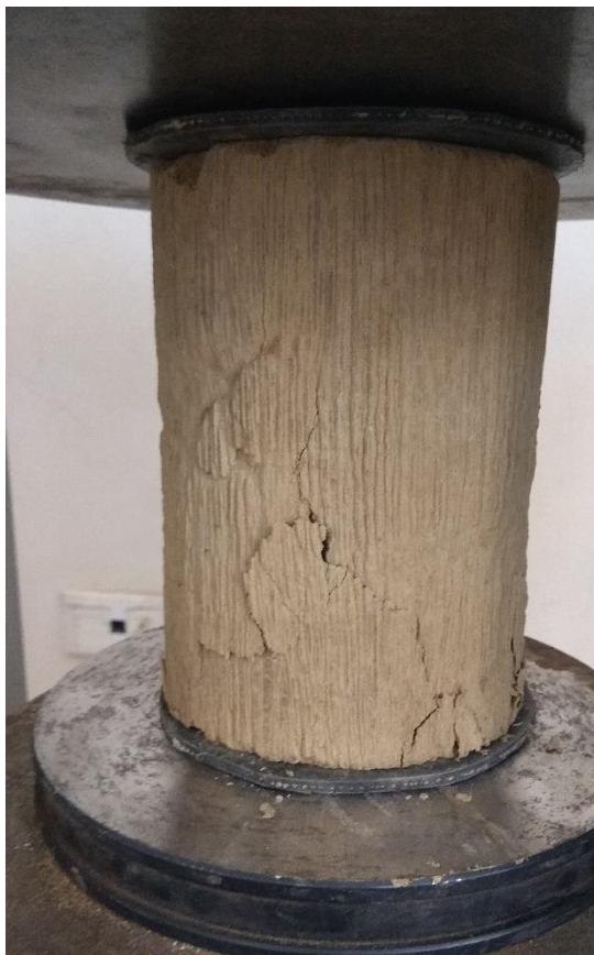
Foto N°13: Rotura de probeta S-C al 5%
