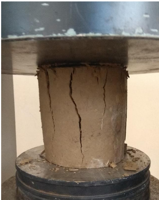
Foto N°8: Rotura de probeta solo suelo N°1
