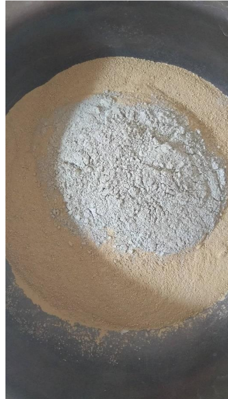
Foto N°12: Mezcla suelo cemento al 8%
