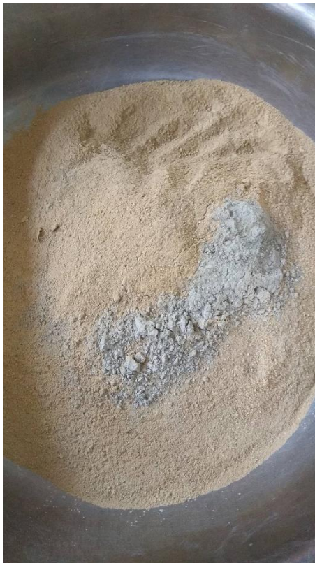
Foto N°11: Mezcla suelo cemento al 3%
