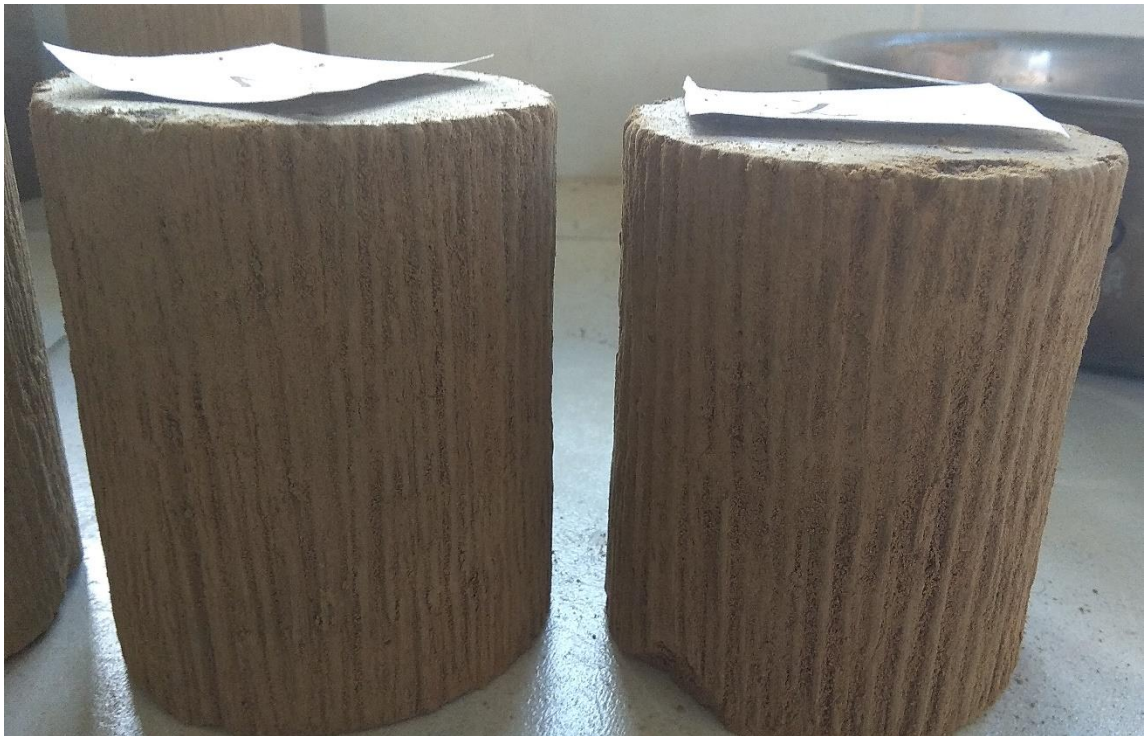
Foto N°10: Desgaste de probetas solo suelo método de raspado
