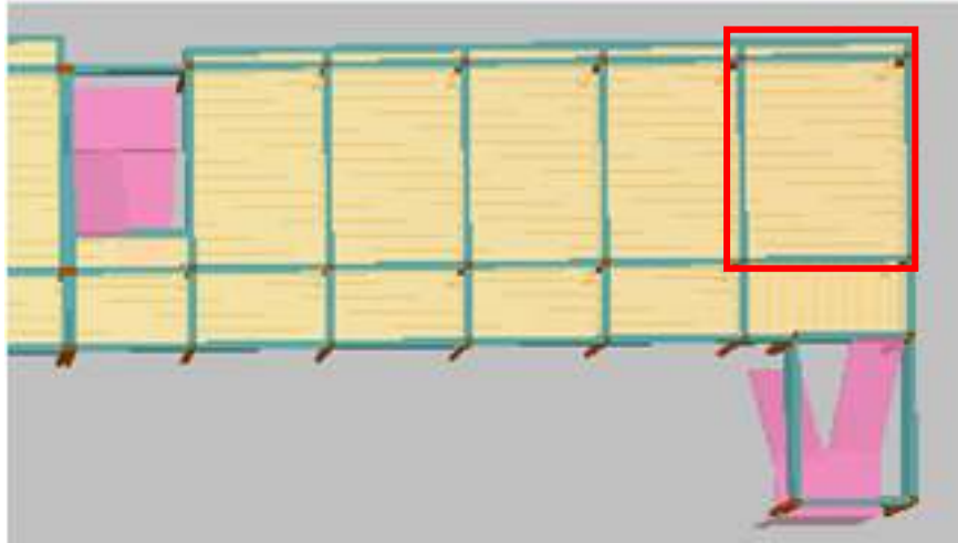
Figura 3-19 Losa alivianada con viguetas pretensadas
