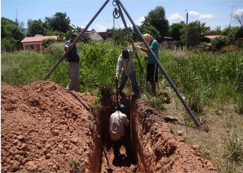
PENETRACIÓN DE PISTÓN EN TERRENO DE FUNDACIÓN
