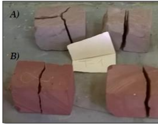
Figura 4.- Tipos de Roturas en las probetas (bloques) ensayadas en el L.S.M.-G.A.M.L.P. A) Bloques del Talud 1, B) Bloques del Talud 8
