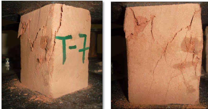
Figura 9.- Rotura de muestra del Talud 7.
