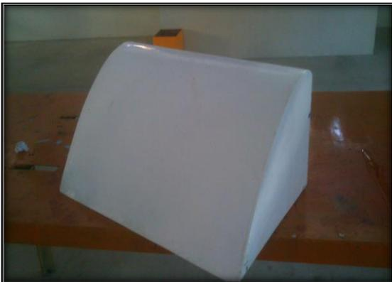
Colocado del vertedero en el canal Rehbock
