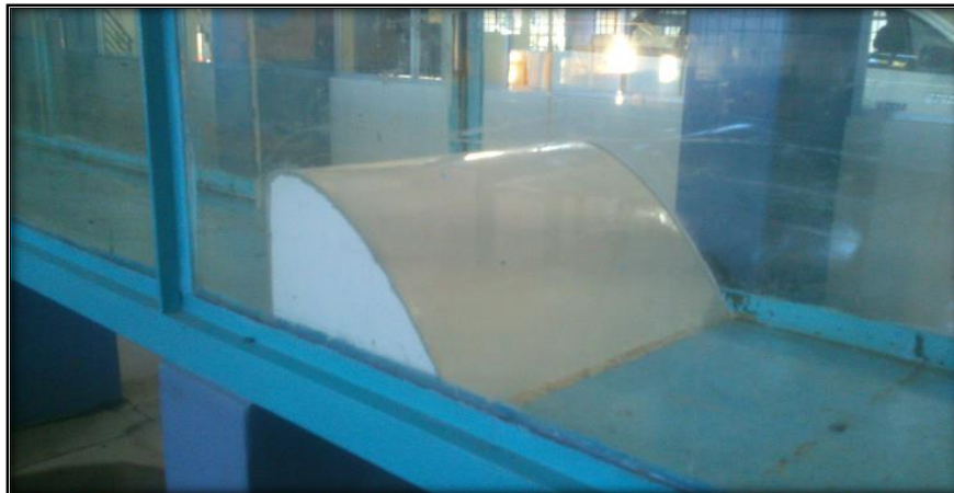
Fotografía 1-3 Vertedero cimacio instalado en el canal Rehbock
