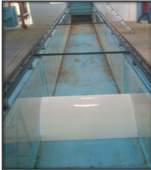
Fotografía 1-2 Instalado el vertedero cimacio en el canal Rehbock
