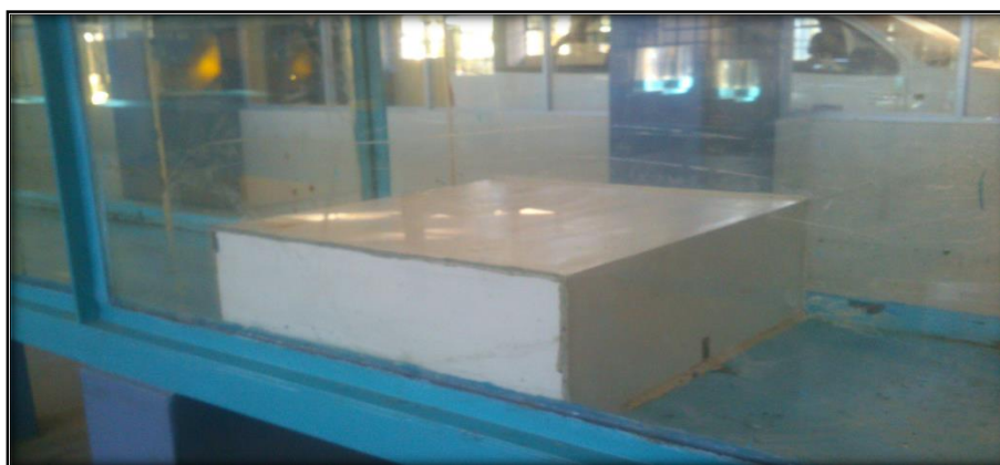
Imagen 2-1 Colocado del vertedero en el canal Rehbock
