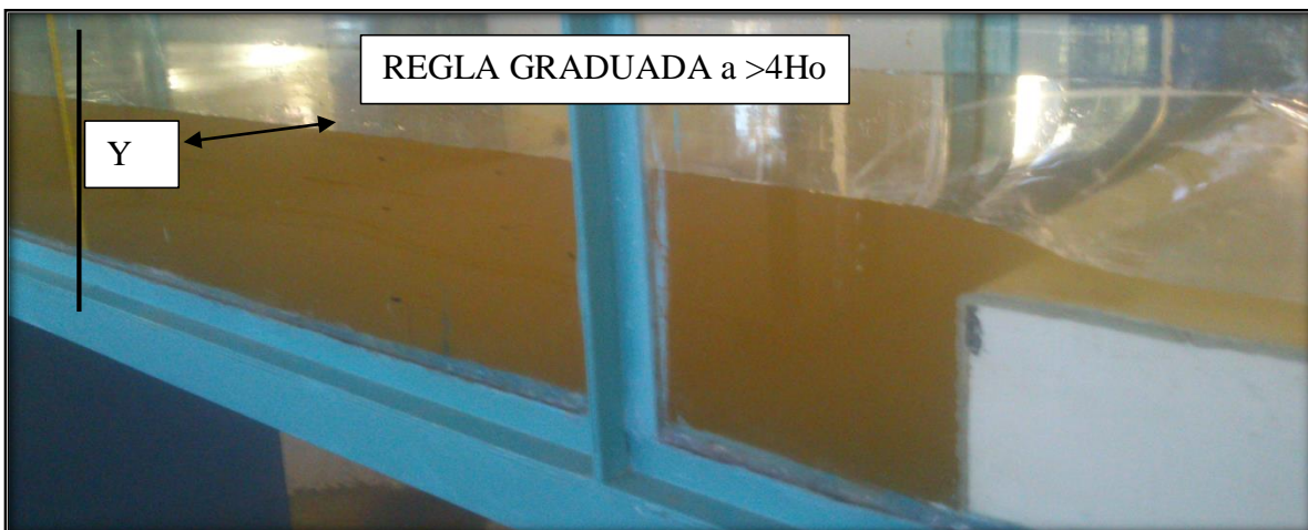
Imagen 2-4 Flujo aguas arriba del vertedero cimacio
