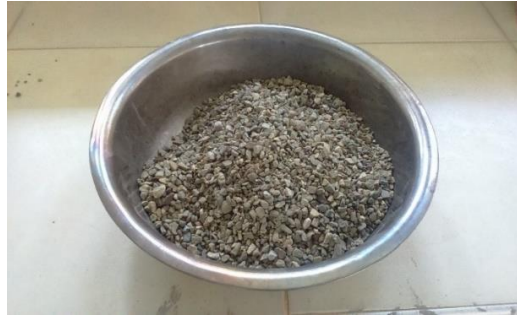
Figura N° 3.4: Agregado grueso - Gravilla.
