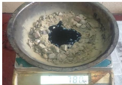
Figura N° 4.1: Pesado de los Materiales.
