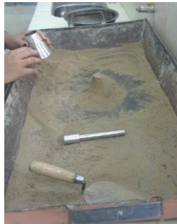
Figura N° 3.6: Peso Específico del Agregado Fino.
