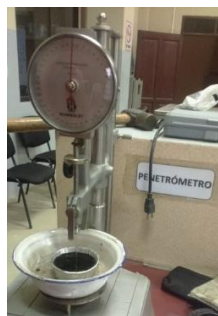
Figura N° 3.11: Realización del Ensayo de Penetración del Cemento Asfáltico .
