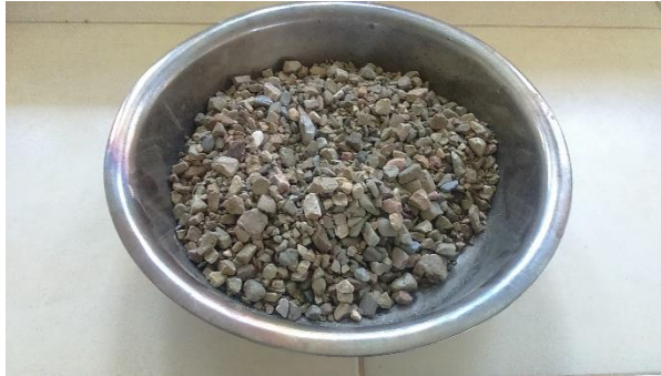
Figura N° 3.3: Agregado Grueso - Grava.
