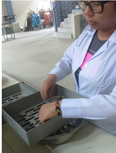
Figura N° 3.10: Partículas Largas y Achatadas.
