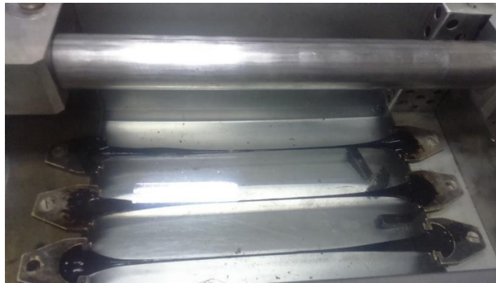
Figura N° 3.15: Realización del Ensayo de Ductilidad del Cemento Asfáltico .
