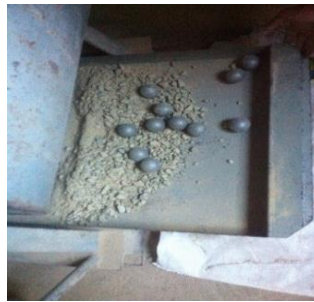
Figura N° 3.2: Máquina de Desgaste por Abrasión y Material Ensayado.
